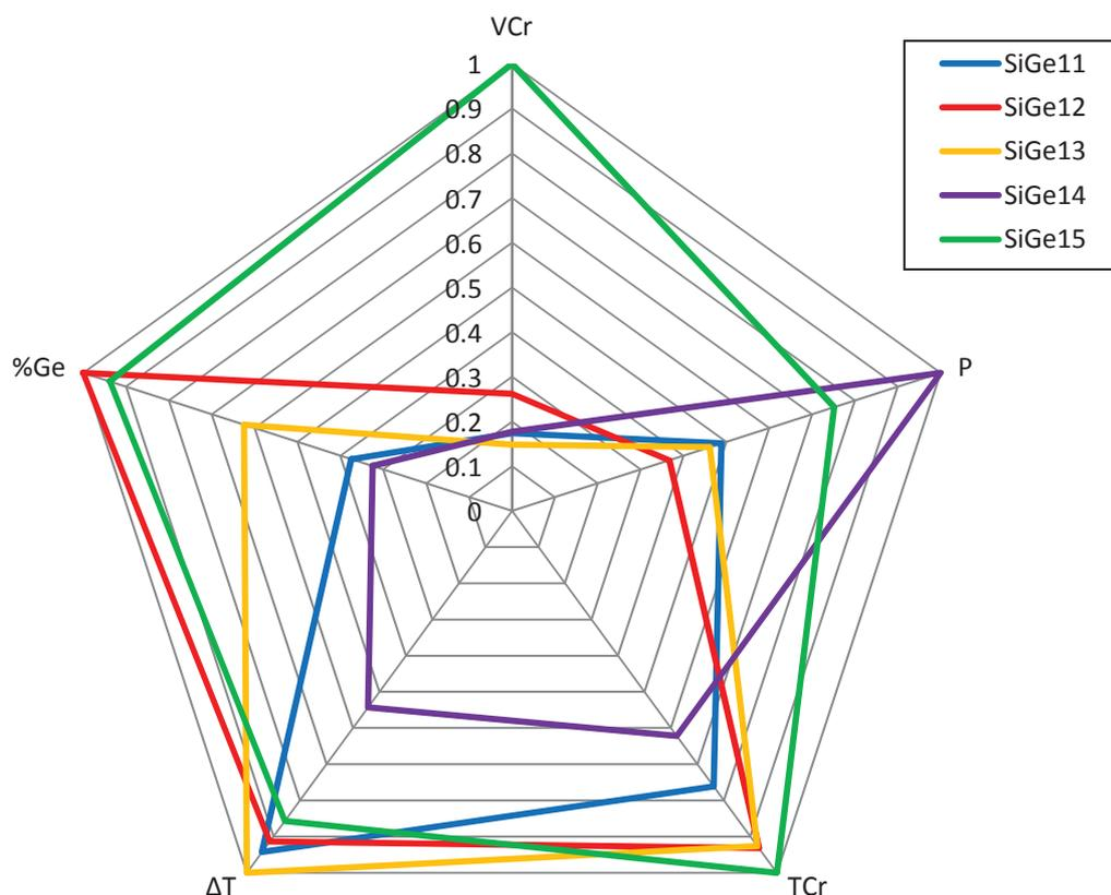
Figure III.7 : Valeurs normalisées des vitesses de croissance, pressions, températures de croissance, gradients de température et taux de germanium moyen dans les cristaux obtenus dans NaOH 0.05M
