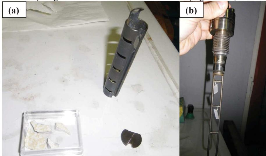
Figure II.5 : panier avec nutriments (a) et échelle pour suspendre les germes (b)
