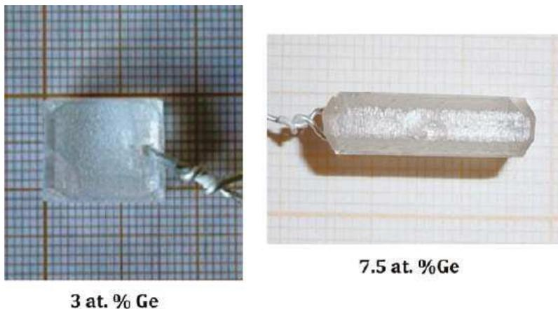
Figure I.12 : Monocristaux de  $\text{Si}_{(1-x)}\text{Ge}_x\text{O}_2$  quartz- $\alpha$  obtenus par croissance hydrothermale<sup>92</sup>
