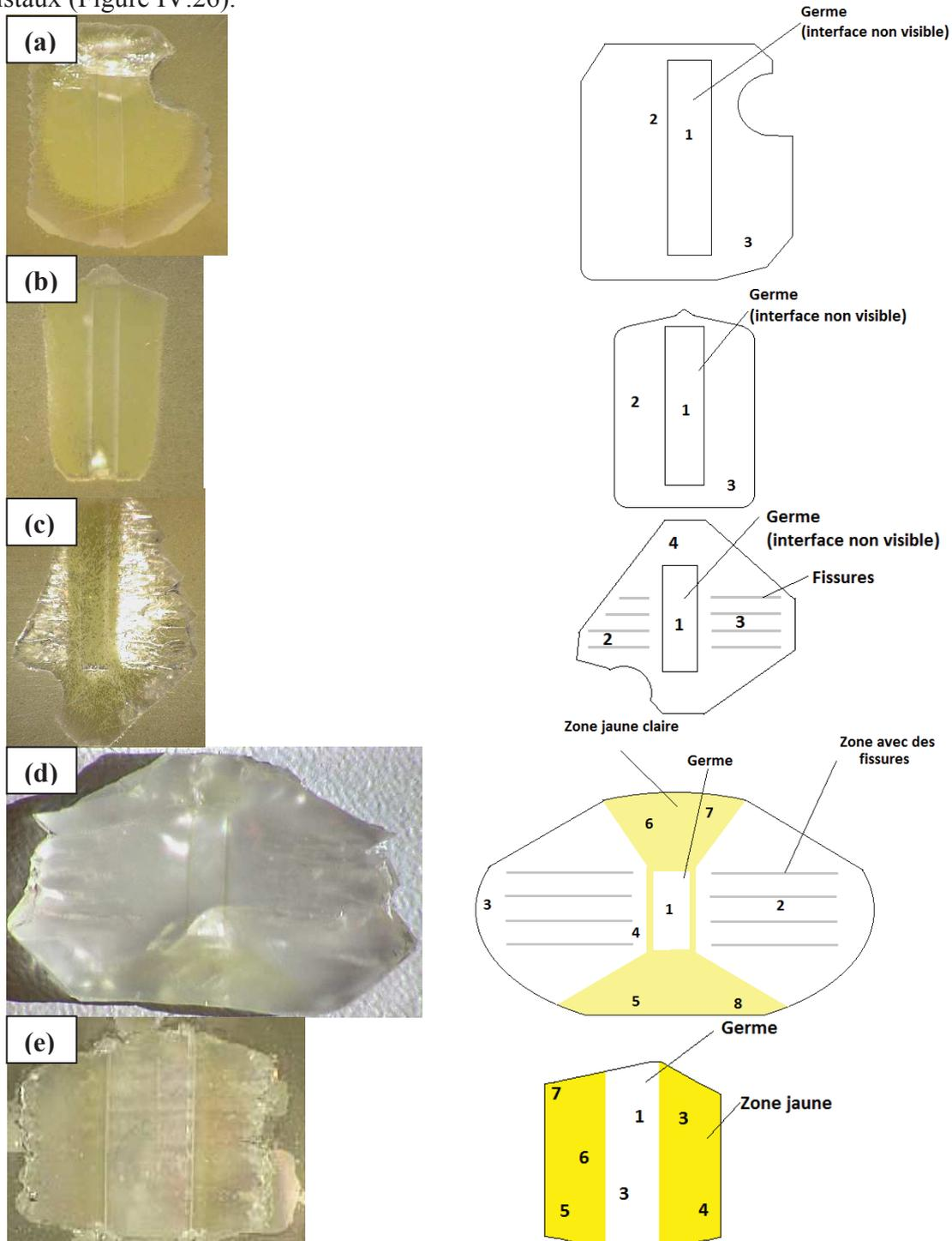
Figure IV.26 : Photographie de coupes Y des cristaux issus des croissances SiTi1H (a), SiTi1B (b), SiTi2 (c), SiTi3 (d) et SiTi4 (e) incluses dans de la résine (sauf celui issu de SiTi3) et schéma des mesures EPMA correspondants
