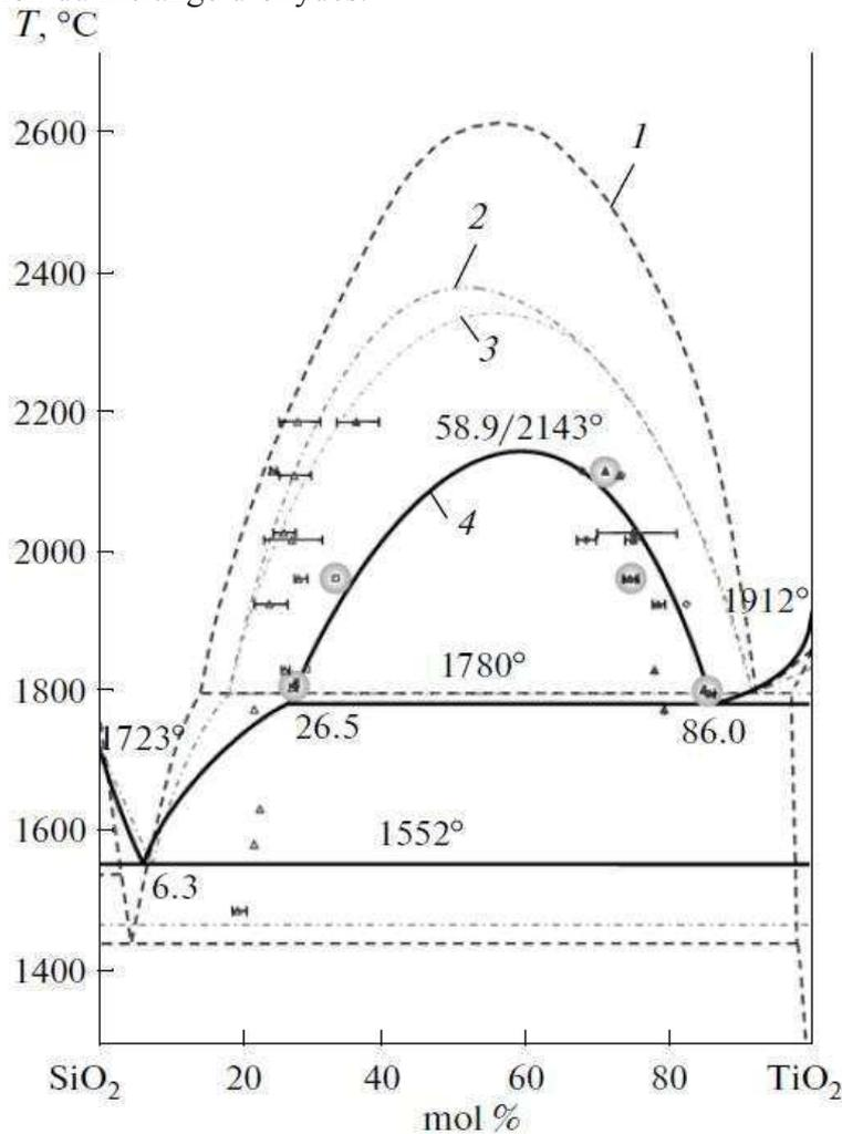
Figure IV.16 : Diagramme de phases pseudo-binaire  $\text{SiO}_2\text{-TiO}_2$  d'après plusieurs auteurs<sup>188-189-190-191</sup>
