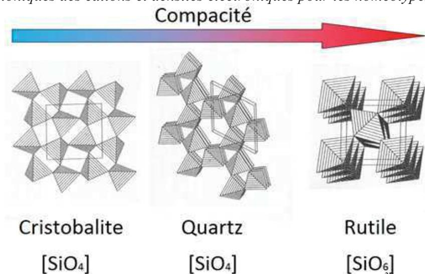
Figure I.4 : Structures cristobalite, quartz et rutile<sup>33</sup>
