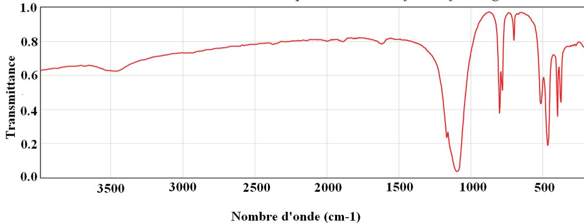
*Figure III.15 : Spectre infrarouge du quartz- $\alpha$   $\text{SiO}_2$  en transmission<sup>149</sup>*
