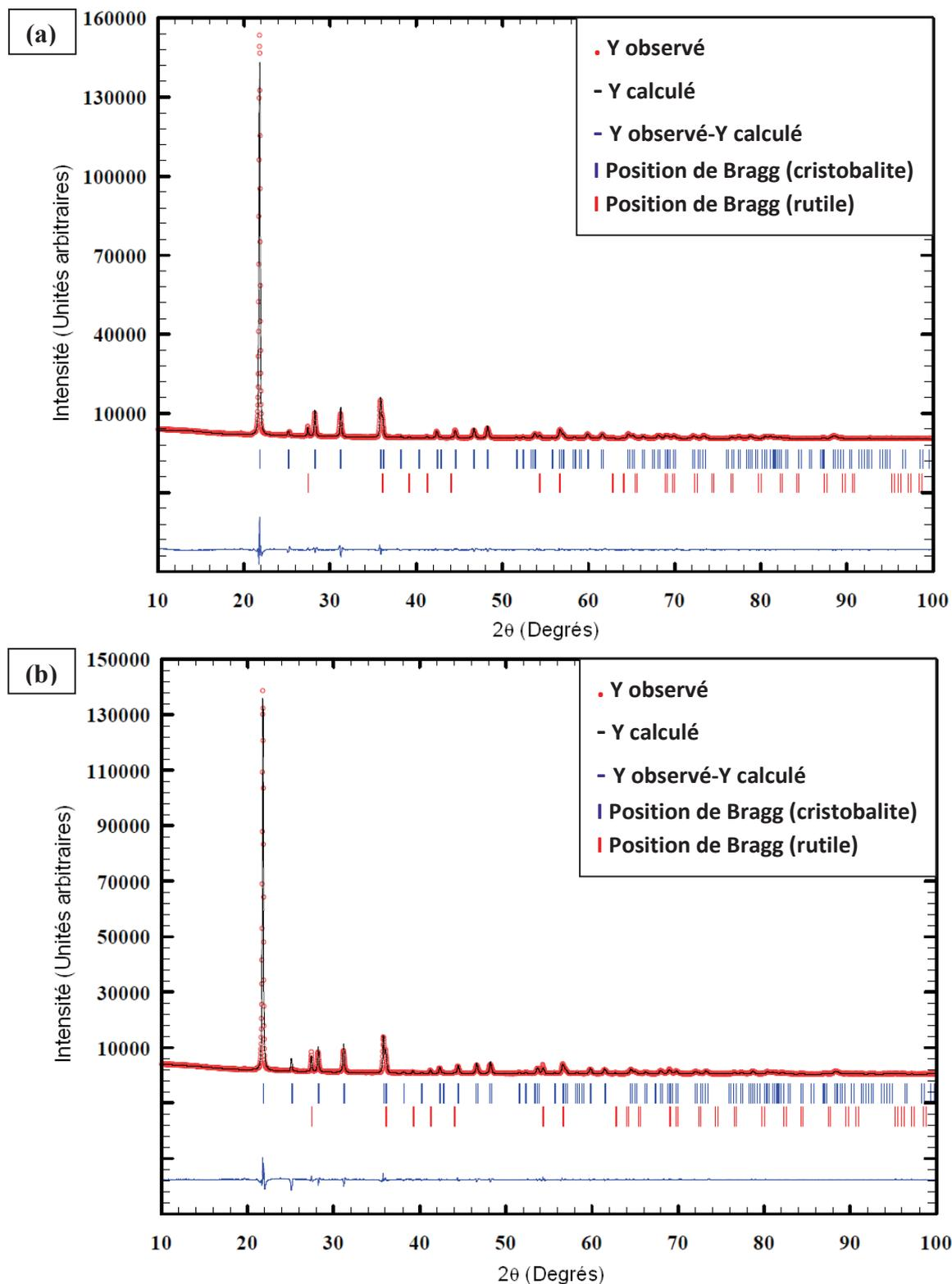
Figure IV.21 : Ajustement des diffractogrammes par la méthode de LeBail des corps-mères
