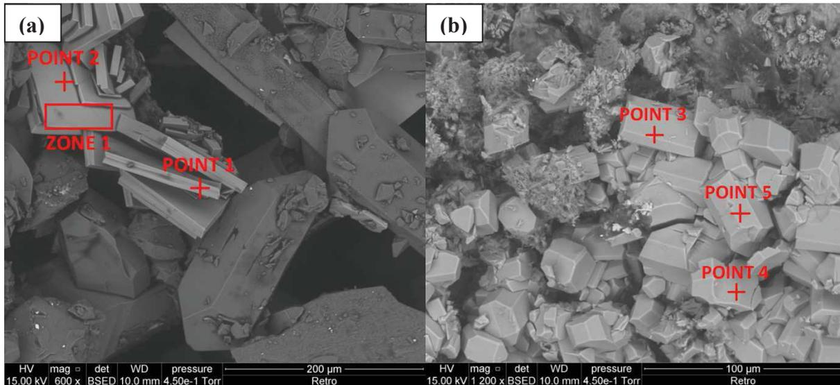
*Figure V.12 : Image MEB rétrodiffusée des dépôts cristallins formés en partie haute de l'autoclave durant le cycle de croissance  $\text{SiSn}_3$  (a) et des résidus de corps-mère du cycle de croissance  $\text{SiSn}_4$  (b)*
