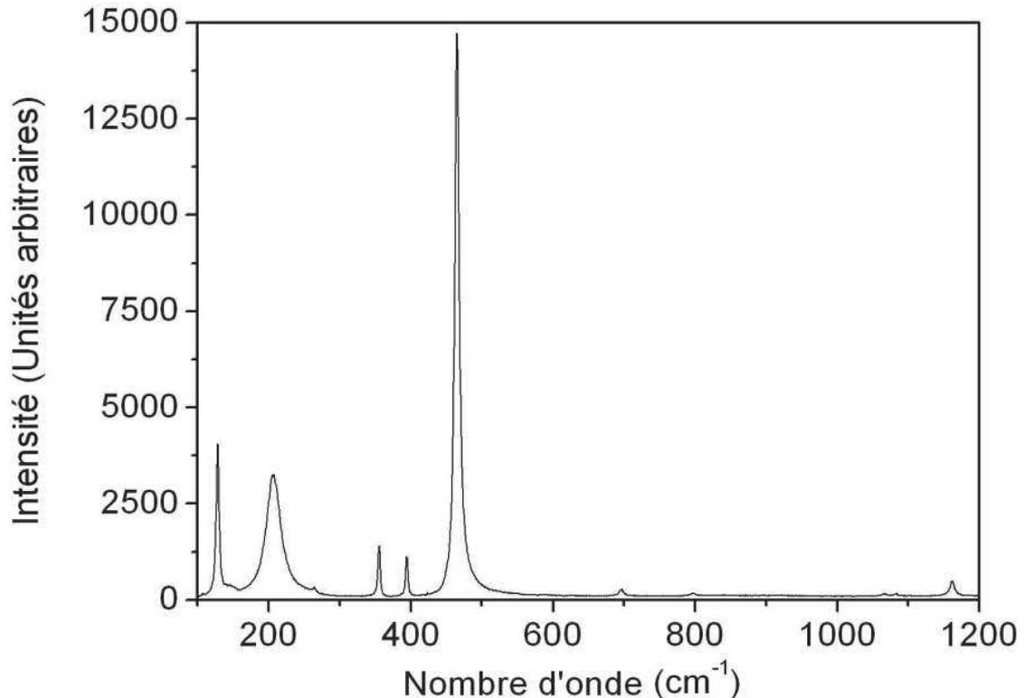
Figure II.28 : Spectre Raman du quartz- $\alpha$   $\text{SiO}_2$  pur obtenu avec un laser rouge ( $\lambda=633\text{nm}$ )
