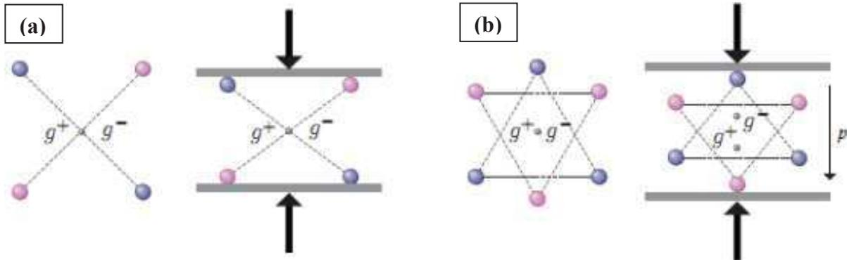
Figure I.7 : Effet d'une contrainte sur les barycentres des charges positives et négatives sur un matériau centro-symétrique (a) et non-centro-symétrique (b)<sup>46</sup>
