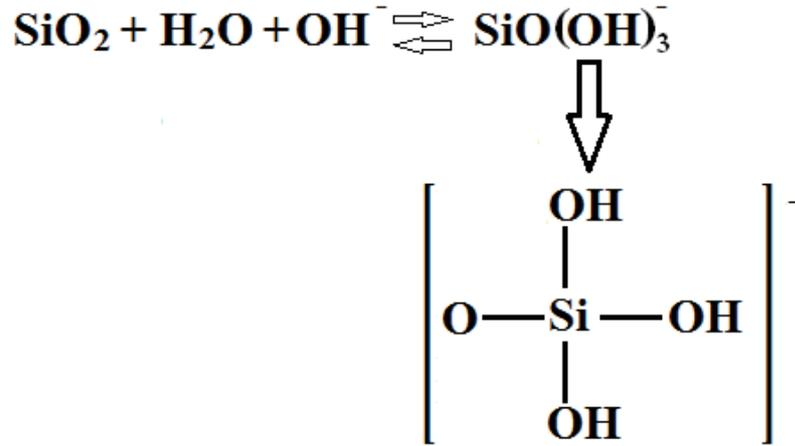
*Figure III.9: Solvation du quartz en milieu basique pour un pH compris entre 12 et 14
