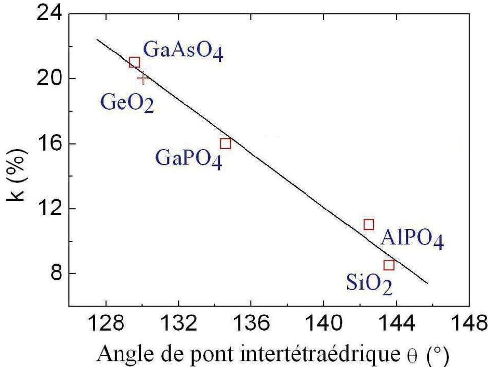
Figure I.8 : Coefficient de couplage électromécanique  $k$  de plusieurs homéotypes du quartz en fonction de leur angle de pont inter-tétraédrique  $\theta$  (valeur estimée pour GeO<sub>2</sub>)
