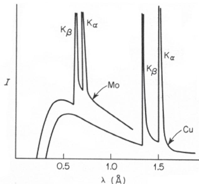
Figure II.12 : Spectre d'émission X du Cuivre et du Molybdène<sup>126</sup>
