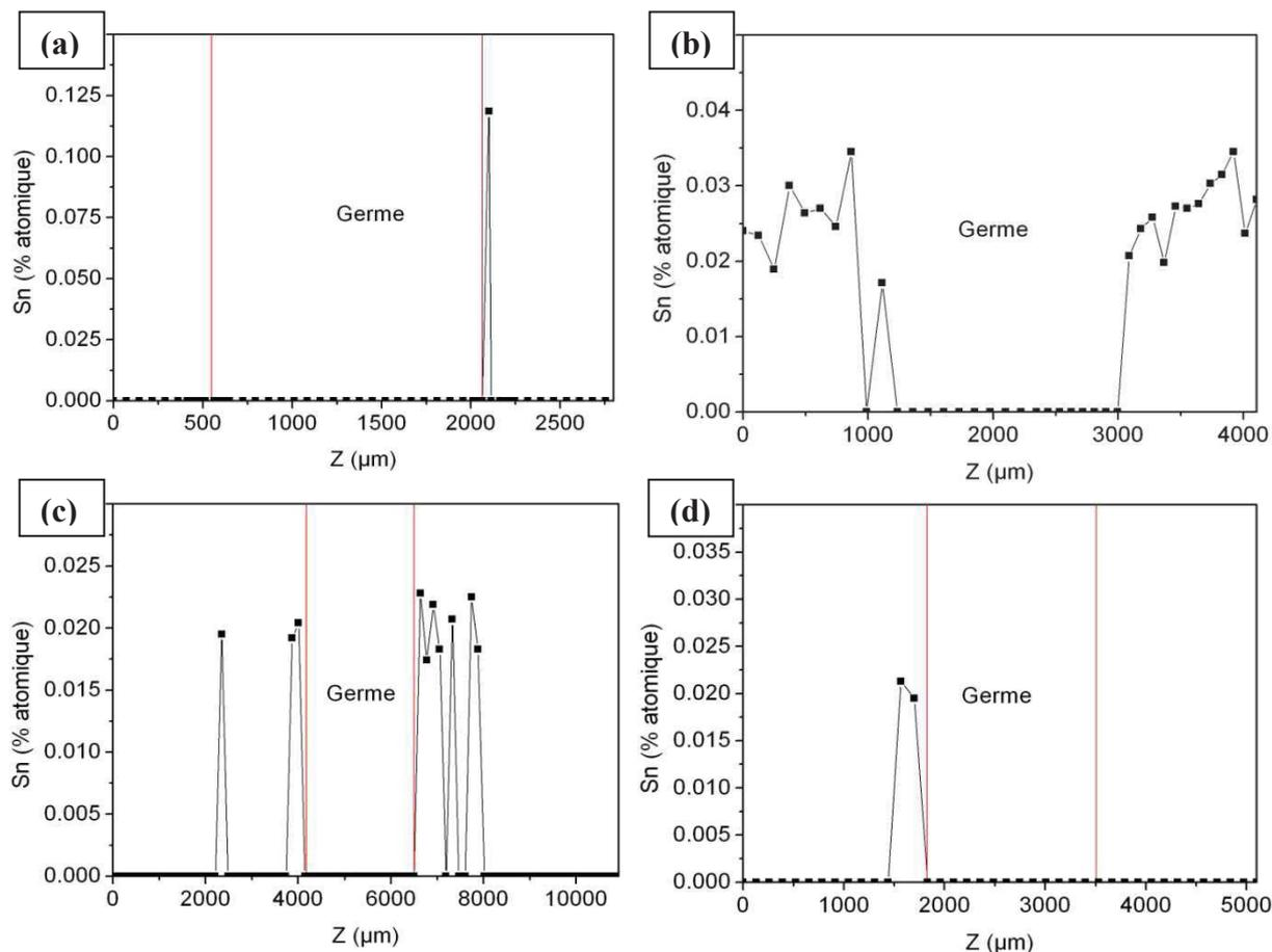
*Figure V.17 : Cartographie EPMA de la teneur en étain des cristaux issus des croissances  $\text{SiGeSn1}$  (a),  $\text{SiSn1}$  (b) et  $\text{SiSn2}$  (c) et  $\text{SiSn3}$ (d) pour les cristaux avec un profil non symétrique, le germe est délimité en rouge*
