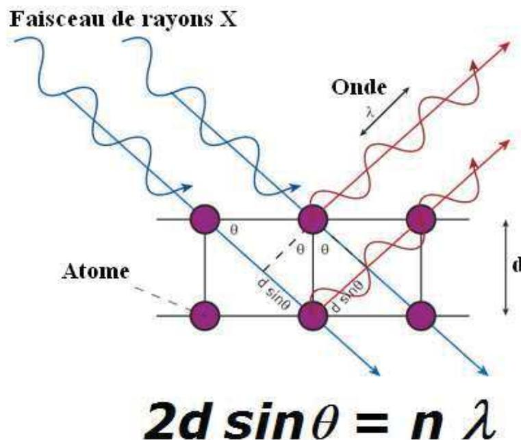
Figure II.13 : Représentation schématique de la diffraction des rayons X par deux plans réticulaire<sup>128</sup>
