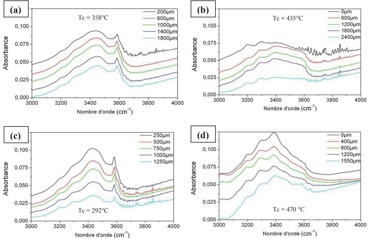
*Figure III.16 : Spectres infrarouge des lames SiGe11Y (a) SiGe13Y (b) SiGe14Y (c) et SiGe15Y (d) ces spectres ont été effectués dans la zone épitaxiée du germe (0 $\mu$ m) vers le bord du cristal*
