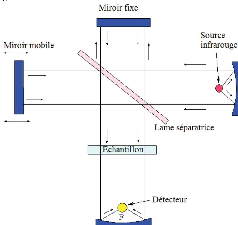
Figure II.32 : Interféromètre de Michelson pour spectroscopie FTIR
