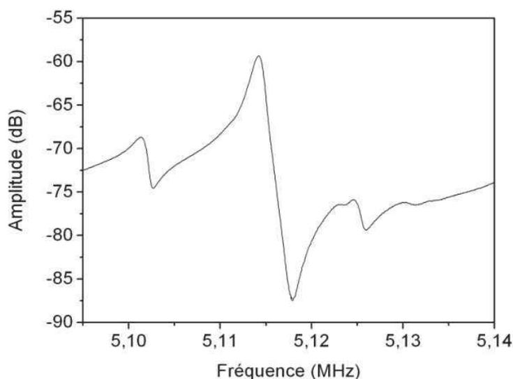
Figure III.21 : Signal piézoélectrique obtenu sur la lame SiGe11Y
