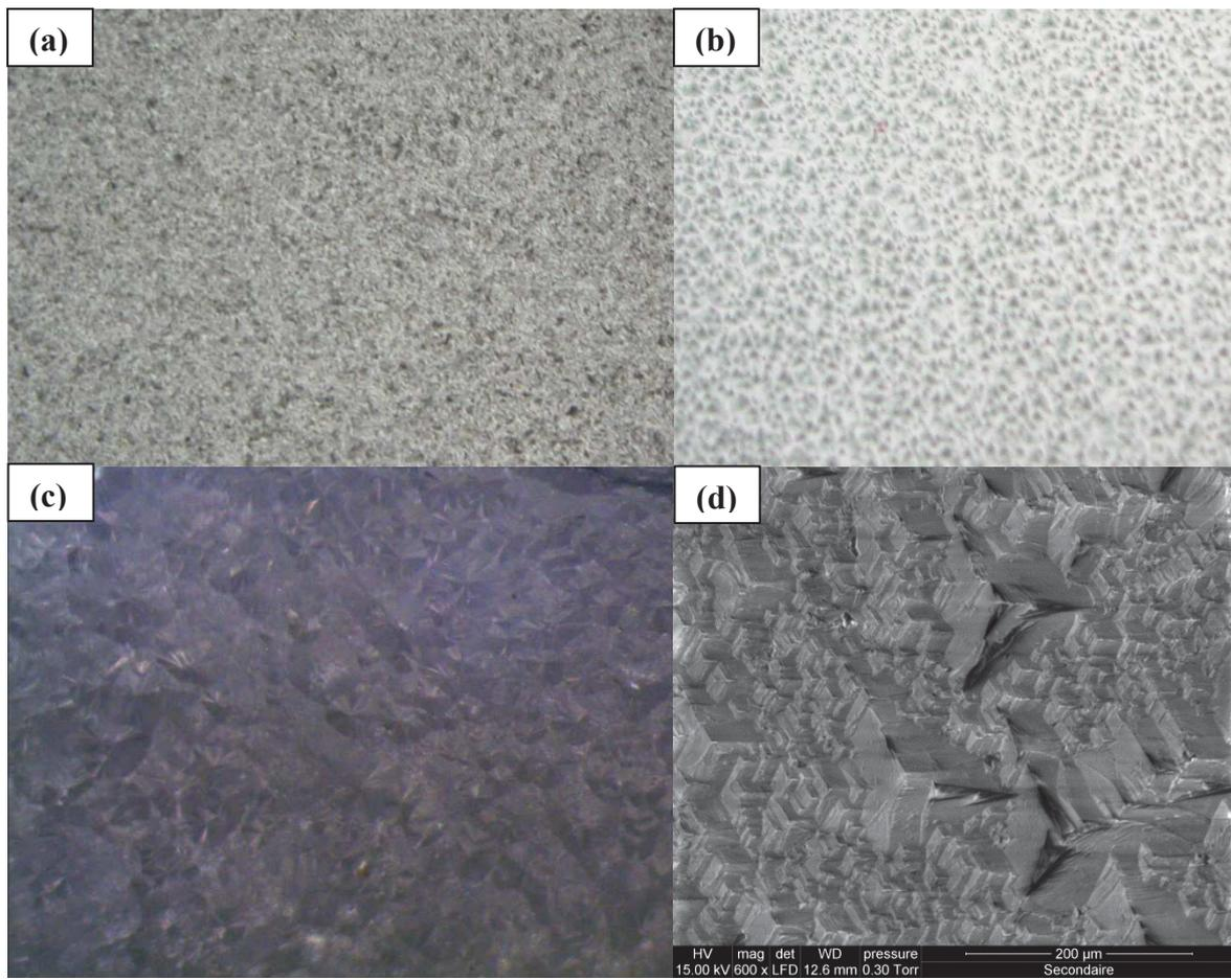
Figure III.4 : Surface d'un germe de quartz avant attaque chimique (a) après attaque chimique (b) et après croissance cristalline observées au microscope optique au grossissement X20 (c) et après croissance observée au microscope électronique à balayage grâce aux électrons secondaires (d)
