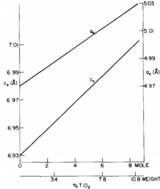
Figure IV.22 : Paramètres de maille de la cristobalite- $\alpha$   $\text{Si}_{(1-x)}\text{Ti}_x\text{O}_2$  en fonction du taux de titane<sup>197</sup>
