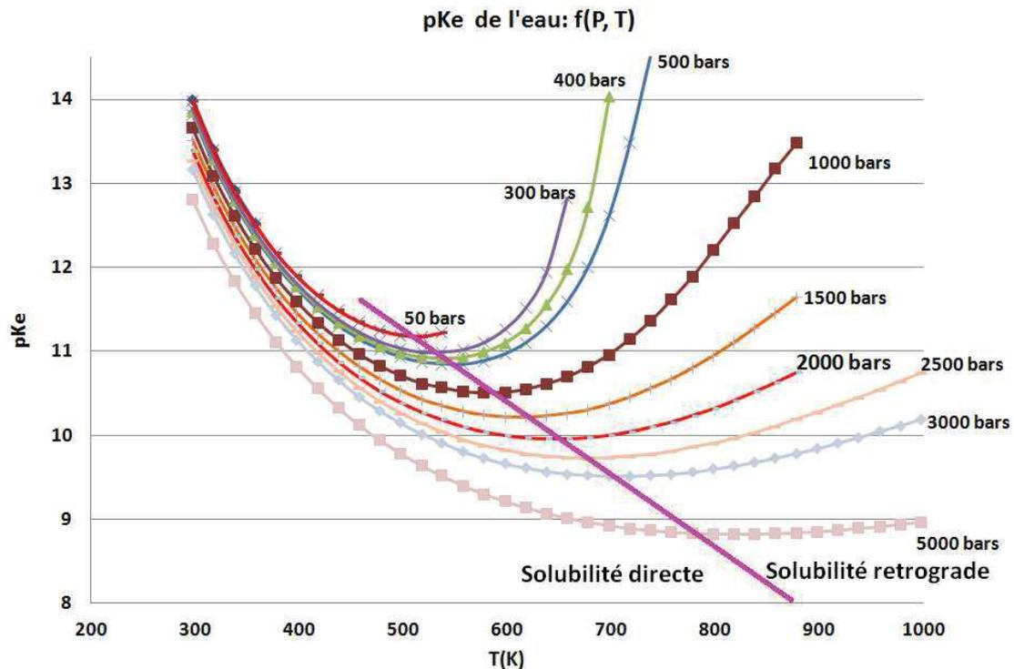
Figure III.12 :  $pK_e$  de l'eau en fonction de la pression et de la température tracé à partir des données de Marshall et Franck<sup>170</sup>
