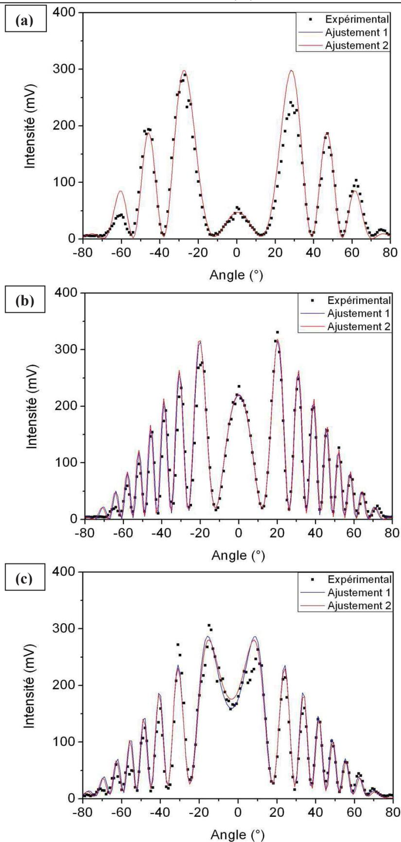
Figure III.27 : Franges de maker obtenues expérimentalement et par ajustement grâce à l'application Chi2 V1.0 d'une référence quartz  $\text{SiO}_2$  (a), de la lame  $\text{SiGe}_{11}\text{Z}$  (b) et de la lame  $\text{SiGe}_{14}\text{Z}$  (c)
