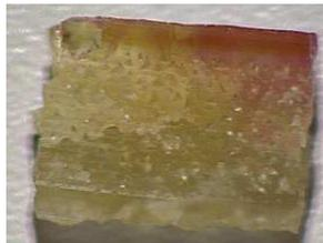
*Figure IV.6 : coupe Z du cristal issu de la croissance SiMn2, la zone rouge est due à de la résine*
