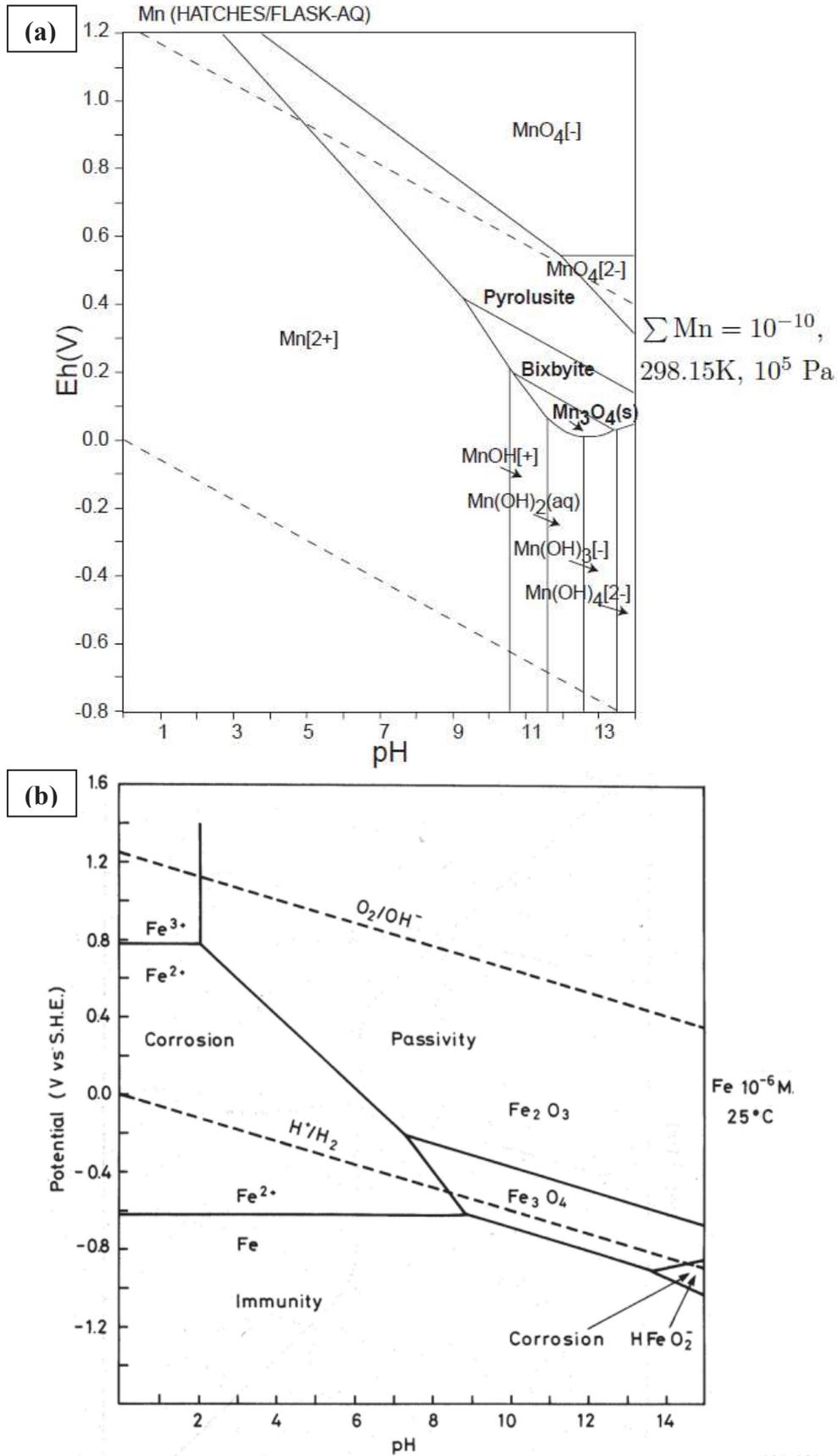
Figure IV.8: Diagrammes potentiel-pH du manganèse (a) et du fer (b)<sup>181-182</sup>
