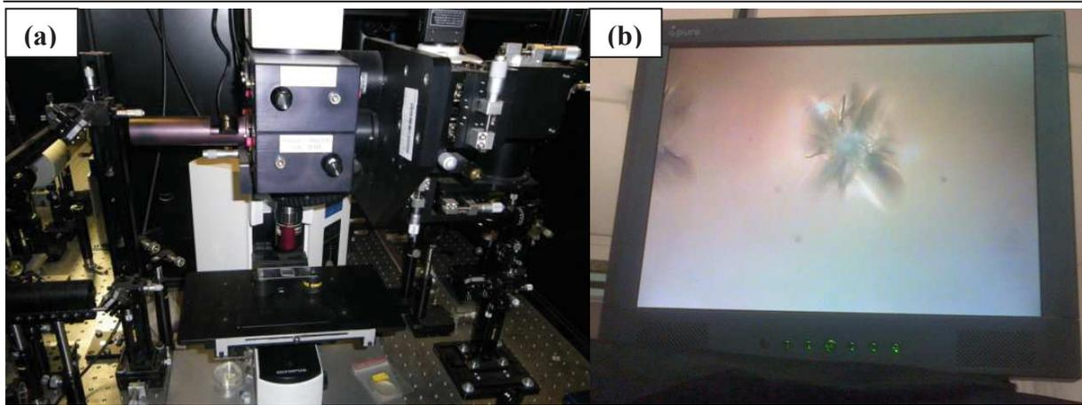
*Figure II.40 : Mesure expérimentale du seuil de dommage optique (a) et visualisation d'un dommage optique dans une lame de quartz à l'aide de la caméra vidéo (b)*
