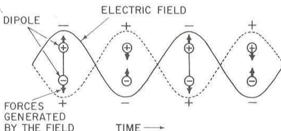
Figure II.30 : Interaction entre un dipôle et un champ électromagnétique<sup>147</sup>
