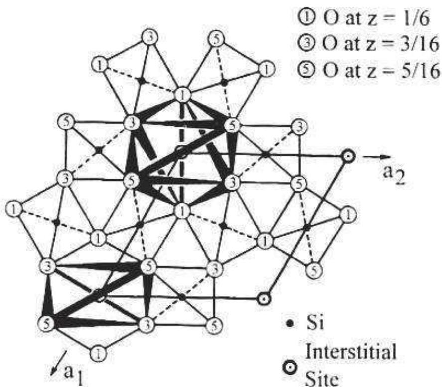
Figure I.9 : Sites interstitiels dans la structure quartz- $\alpha$ <sup>78</sup>
