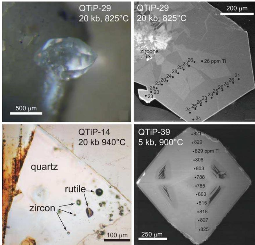
Figure I.15 Monocristaux de quartz enrichis au titane et au zirconium<sup>105</sup>
