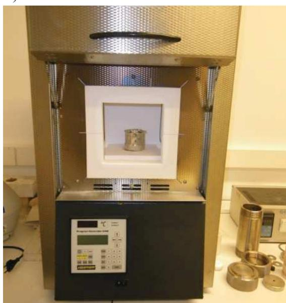
*Figure II.11 : Four Nabatherm LHT 04/17 avec creuset de platine*
