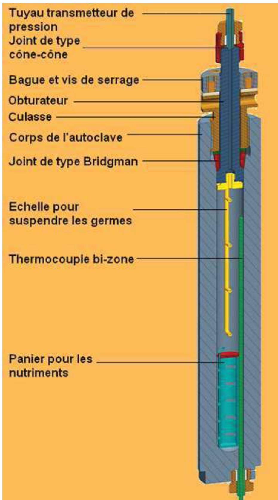
Figure II.4 : Schéma de l'autoclave « TOP100 »
