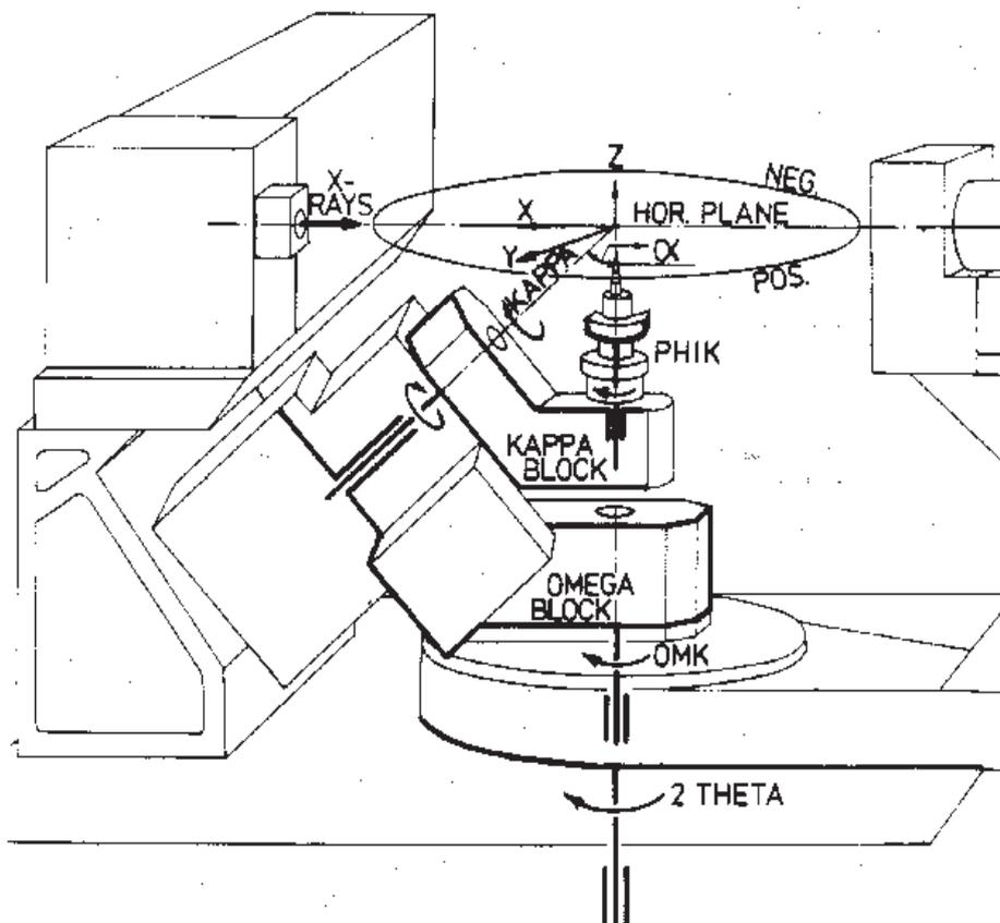
Figure II.17 : Géométrie 4 cercles permettant de collecter les données de diffraction d'un maximum de plans cristallins
