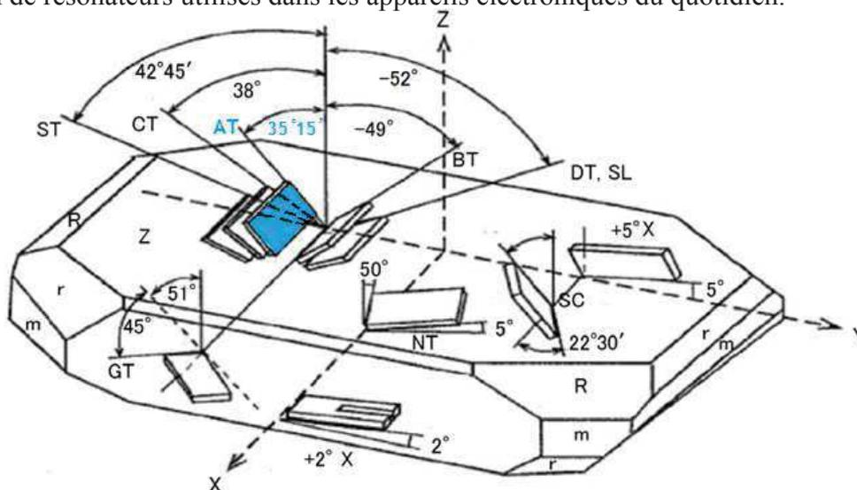
Figure II.37 : Les principales coupes cristallines piézoélectriques taillées dans le quartz  $\text{SiO}_2$ <sup>156</sup> et la dénomination de ses faces (Annexe 2)
