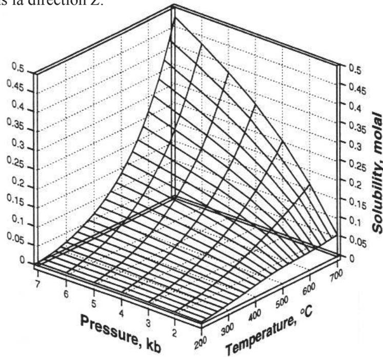
Figure III.11 : Solubilité du quartz en fonction de la pression et de la température dans l'eau<sup>169</sup>
