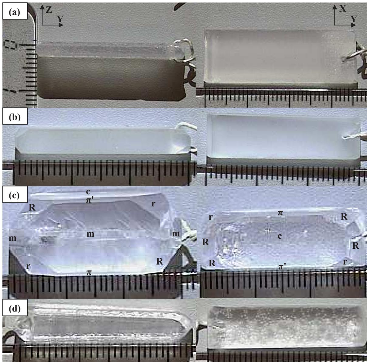
Figure V.10: Photographies des cristaux provenant des croissances SiGeSn1 (a), SiSn1 (b) et SiSn2 (c) et SiSn3(d) selon l'axe X et selon l'axe Z avec la dénomination des faces pour SiSn2 (les faces  $\pi$  et  $\pi'$  ont été dénommées arbitrairement ne sachant pas si le cristal est de type gauche ou droit)
