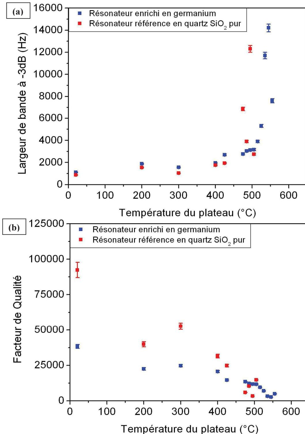
Figure III.24 : Evolution en fonction de la température du plateau la largeur de bande (a) et du facteur de qualité  $Q$  (pour la référence quartz  $\text{SiO}_2$  et pour le résonateur enrichi en germanium)
