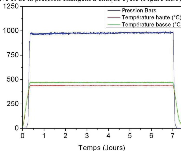
*Figure III.6 : Paramètres thermodynamiques du cycle de croissance  $\text{SiGe}12$*
