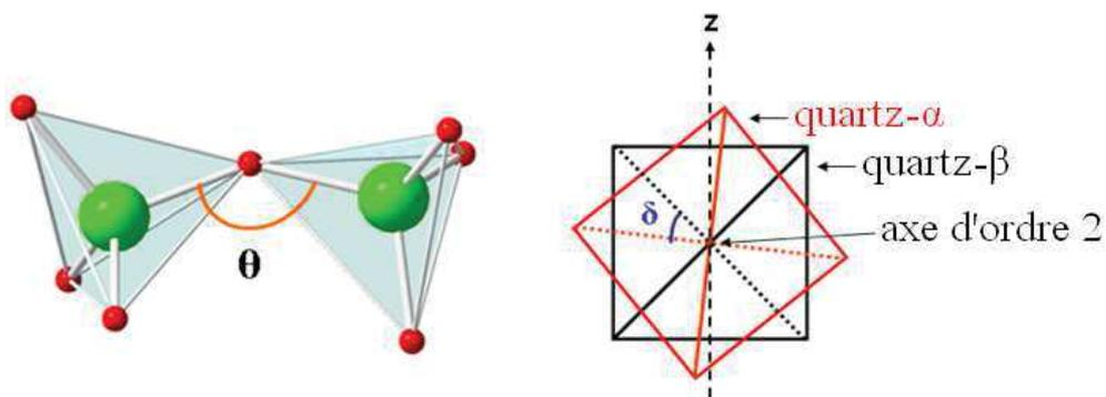
*Figure I.2 : Angles  $\theta$  et  $\delta$  dans la structure du quartz*
