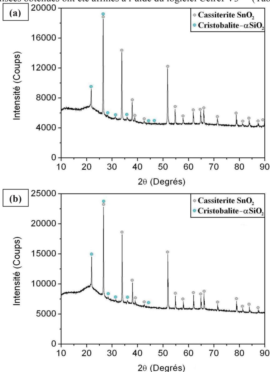
Figure V.5 : Diffractogrammes des corps-mères CM SiGeSn 4-4-2 (a) et CM SiGeSn 4-4-2 bis (b)
