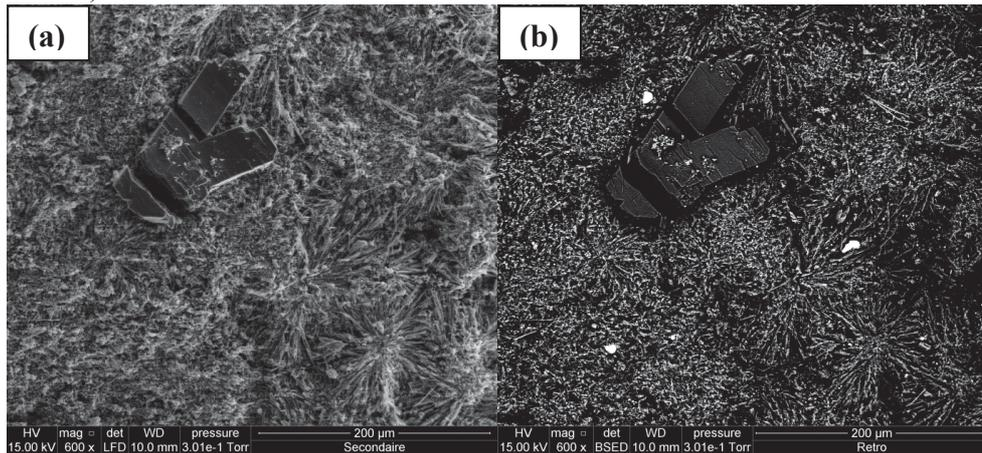
Figure IV.13 : Dépôts de  $\text{VO}_2$  en image secondaire (a) et en image rétrodiffusée (b) en partie supérieure de l'autoclave après la croissance SiGeV2 au milieu de précipités contenant du silicium et du germanium
