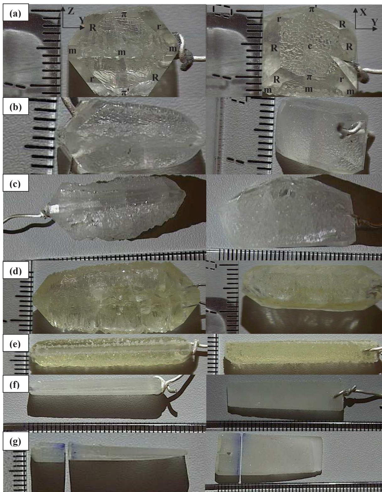
Figure IV.23 : Photographies des cristaux issus des croissances  $\text{SiTi1H}$  (a),  $\text{SiTi1B}$  (b),  $\text{SiTi2}$  (c),  $\text{SiTi3}$  (d),  $\text{SiTi4}$  (e),  $\text{SiGeTi1}$  (f) et  $\text{SiGeTi2}$  (g) selon l'axe X et selon l'axe Z avec la dénomination des faces pour  $\text{SiTi1}$  (Annexe 2), les faces  $\pi$  et  $\pi'$  ont été dénommées arbitrairement ne sachant pas si le cristal est gauche ou droit
