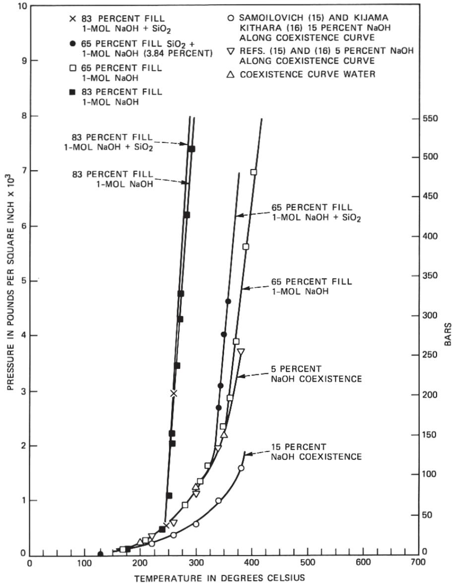
Figure III.5 : Comparaison des abaques de pression en fonction de la température pour différentes concentrations de NaOH<sup>163</sup>
