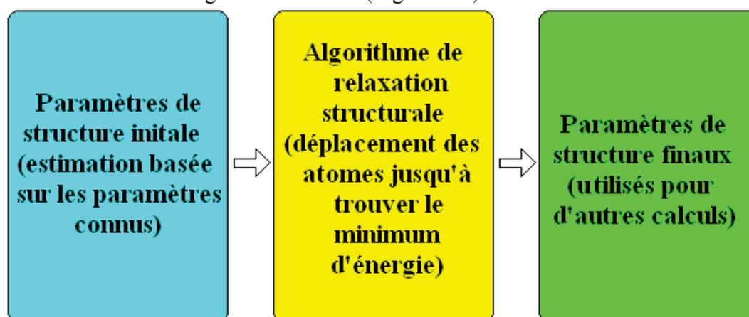
Figure V.1 : Principe itératif de relaxation structurale en DFT
