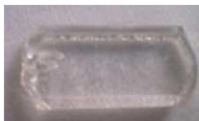
Figure I.14 : Monocristal de quartz contenant 1% de SnO<sub>2</sub><sup>20</sup>
