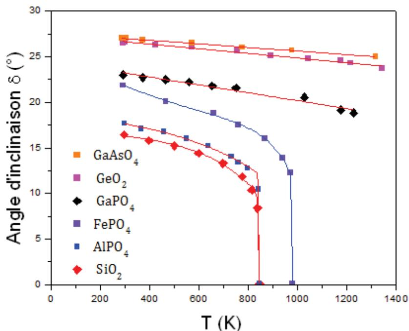
Figure I.6 : Stabilité thermique des homéotypes du quartz<sup>43</sup>
