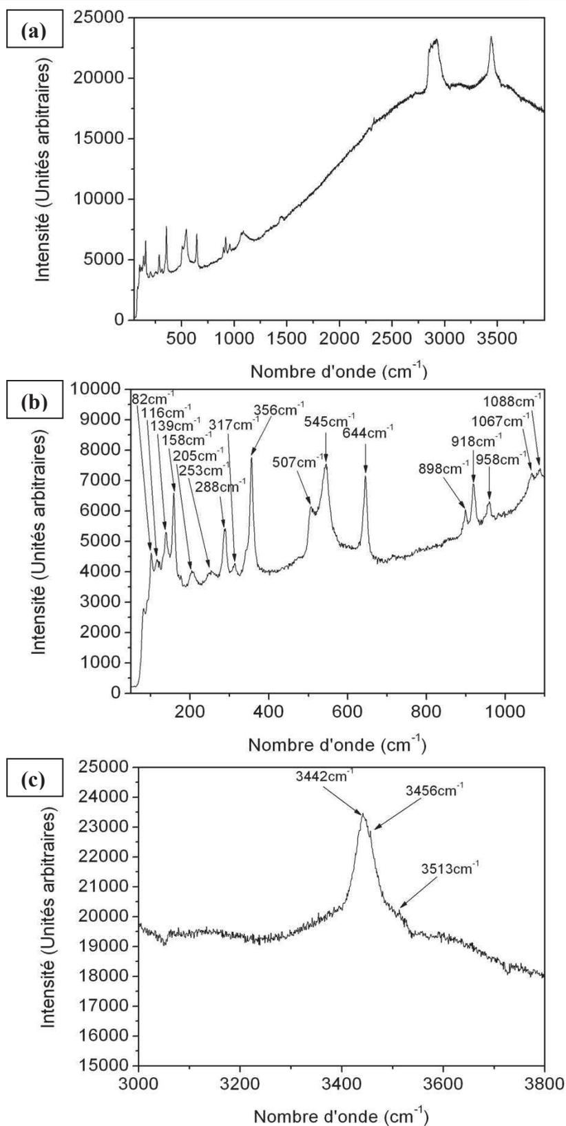
*Figure V.15 : Spectre Raman obtenu avec le laser bleu ( $\lambda = 473\text{nm}$ ) du monocristal provenant des dépôts provenant du cycle de croissance  $\text{SiSn3}$  (a) puis zoom sur les sur fréquences allant de 50 à  $1100\text{cm}^{-1}$  (b) et sur fréquences allant de 3000 à  $3800\text{cm}^{-1}$  (c)*
