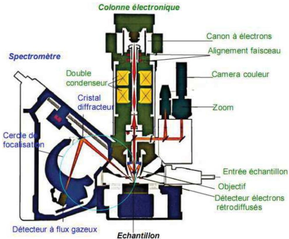
Figure II.25 : Schéma d'une microscopie WDS
