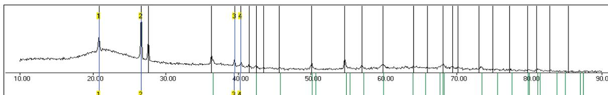
*Figure A3.11 : Diffractogramme avec pics de diffraction pointés et pics de diffraction calculés de la phase de type quartz- $\alpha$  du corps-mère CM SiGeTi 4-5-1*
