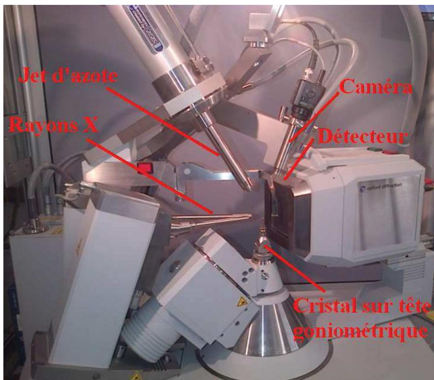
Figure II.18 : Diffractomètre 4 cercles de type Gemini-S de chez Agilent Technologies
