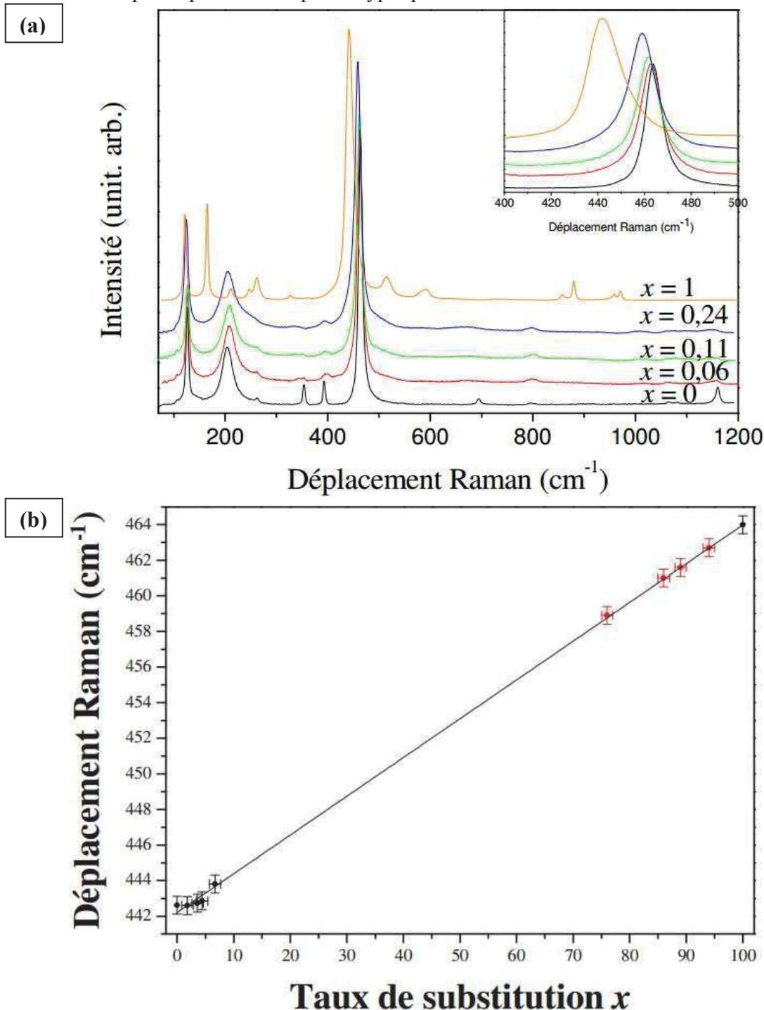
Figure I.13 : Evolution du spectre Raman de  $\text{Si}_{(1-x)}\text{Ge}_x\text{O}_2$  en fonction de  $x$ , teneur en germanium (a) et déplacement Raman du pic principal correspondant au mode de vibration O-Si/Ge-O dans le tétraèdre tracé dans le pseudo- binaire  $\text{SiO}_2\text{-GeO}_2$  (b)<sup>94-95</sup>
