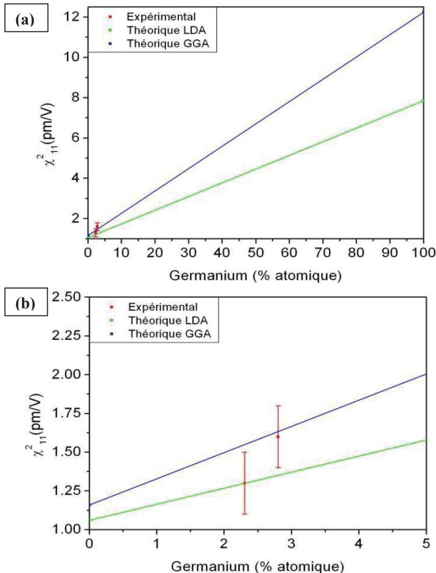
Figure III.28 : Coefficient  $\chi^{(2)}_{11}$  obtenu en fonction du taux de germanium des lames sur tout le binaire, expérimental et théoriques calculés par LDA et GGA (a) et zoom sur les faibles teneurs en germanium (b)
