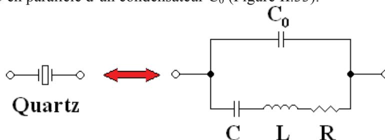
Figure II.33 : Circuit électronique équivalent à un résonateur piézoélectrique
