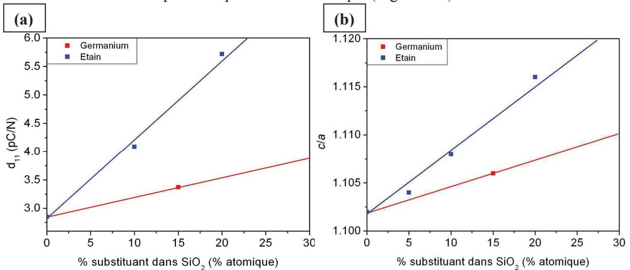
Figure V.2 : Evolution dans le binaire SiO<sub>2</sub>-AO<sub>2</sub> du coefficient piézoélectrique  $d_{11}$  (a) et du rapport  $c/a$  (b)
