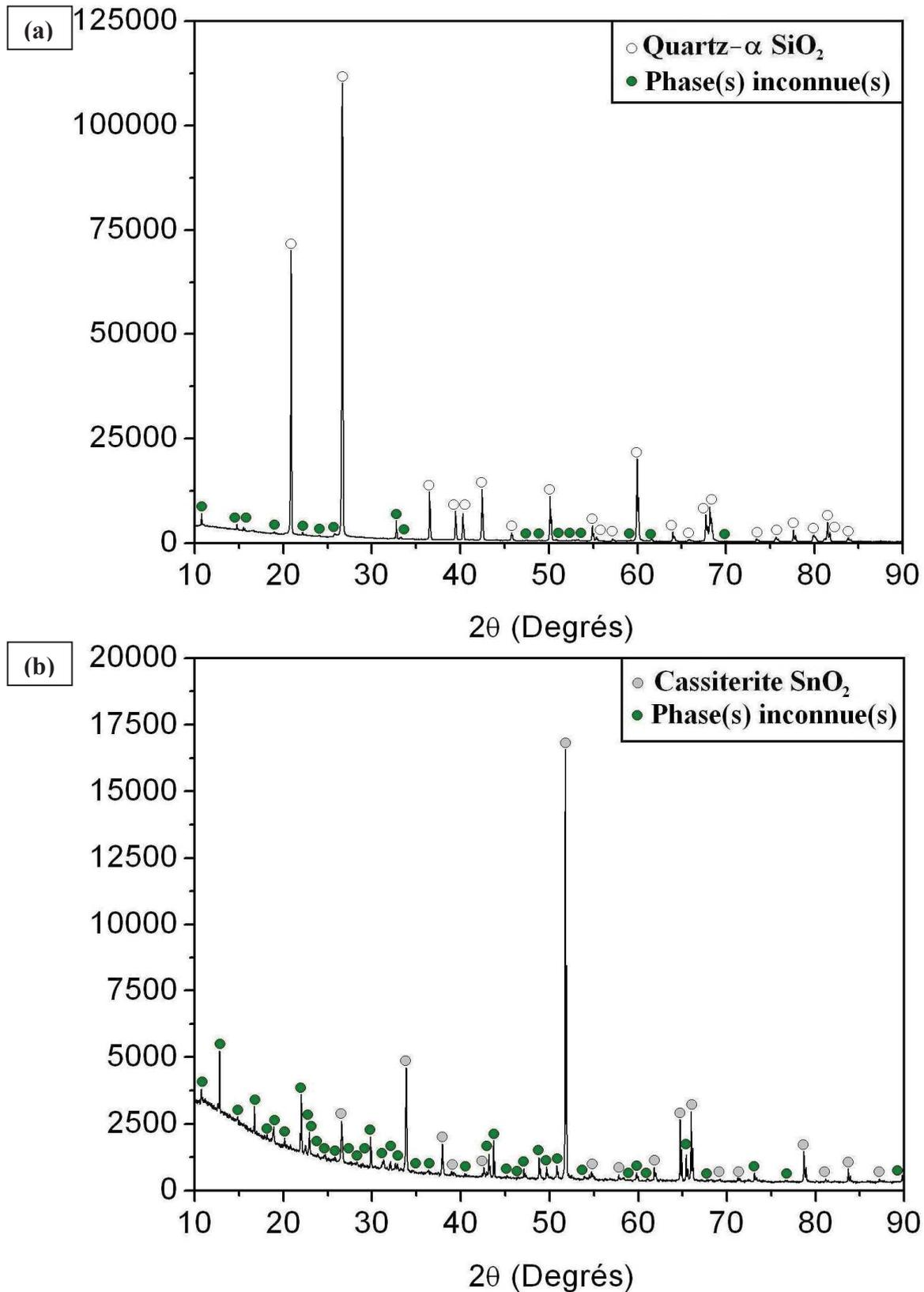
Figure V.11 : Diffractogrammes des dépôts cristallins formés en partie haute de l'autoclave durant le cycle de croissance  $\text{SiSn3}$  (a) et des résidus de corps-mère du cycle de croissance  $\text{SiSn4}$  (b)
