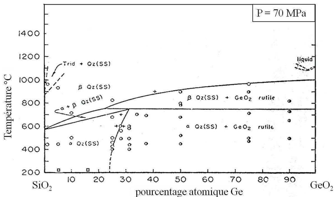
Figure I.10 : Pseudo-binaire  $SiO_2-GeO_2$  expérimental<sup>86</sup>
