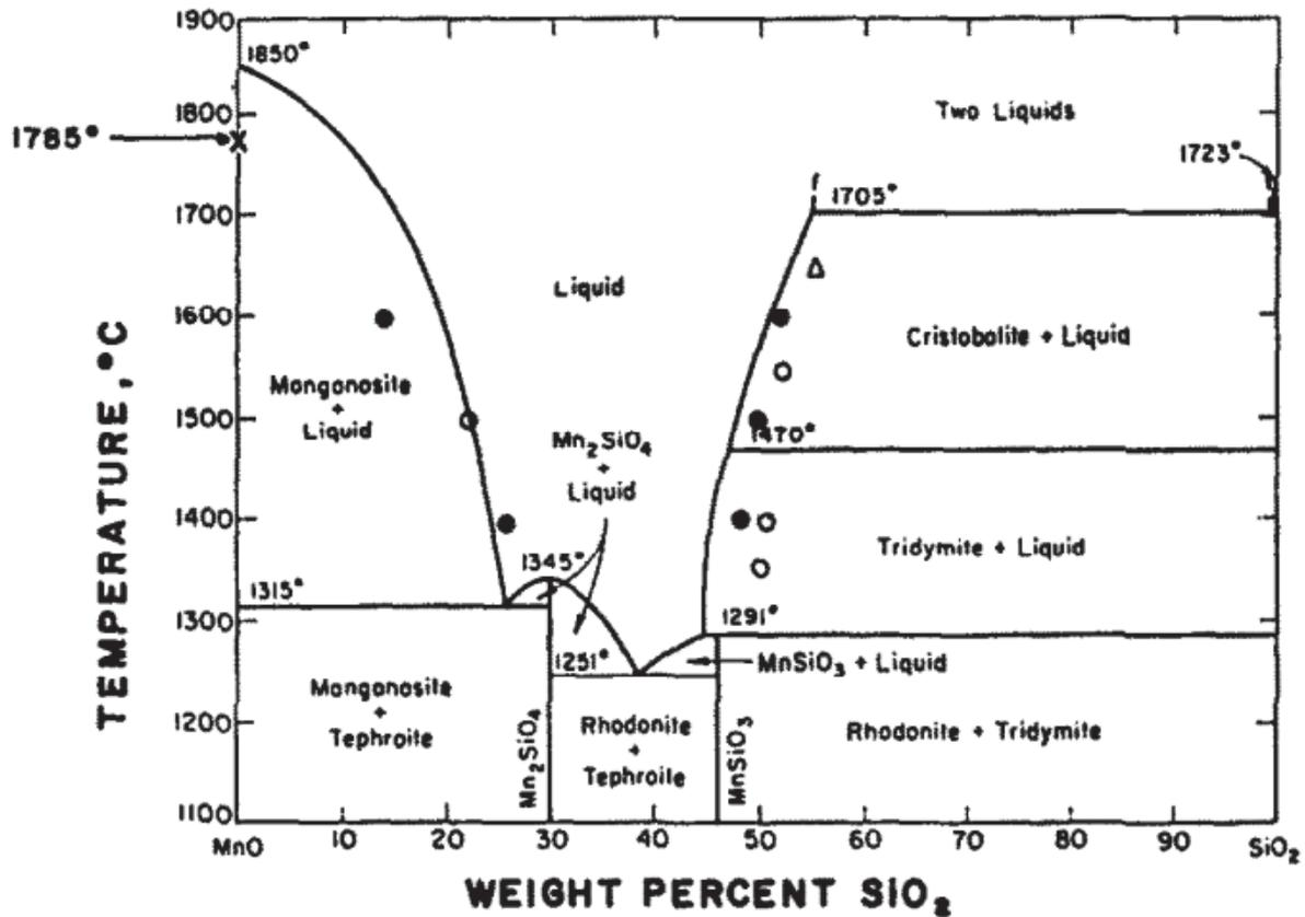
Figure IV.4 : Diagramme de phases pseudo-binaire MnO-SiO<sub>2</sub><sup>178</sup>
