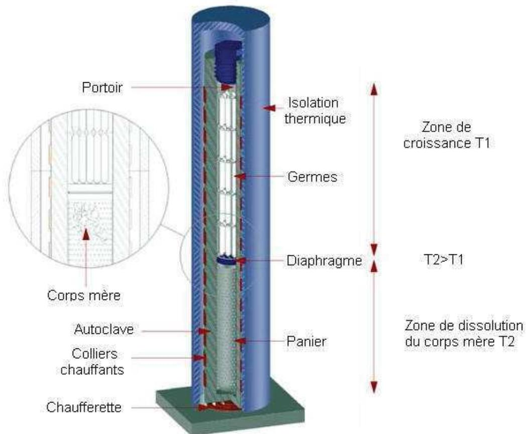
Figure II.3 : Schéma d'un autoclave à gradient vertical de température<sup>118</sup>
