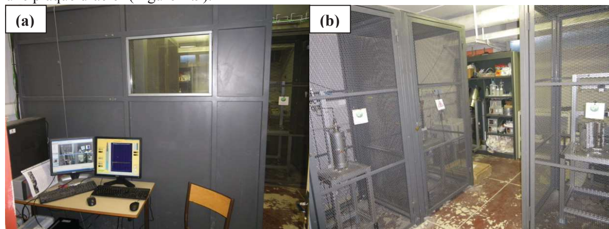
Figure II.9 : poste de pilotage des autoclaves (a) et cages de sécurité (b)
