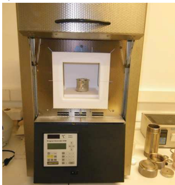
Figure II.11 : Four Nabatherm LHT 04/17 avec creuset de platine
