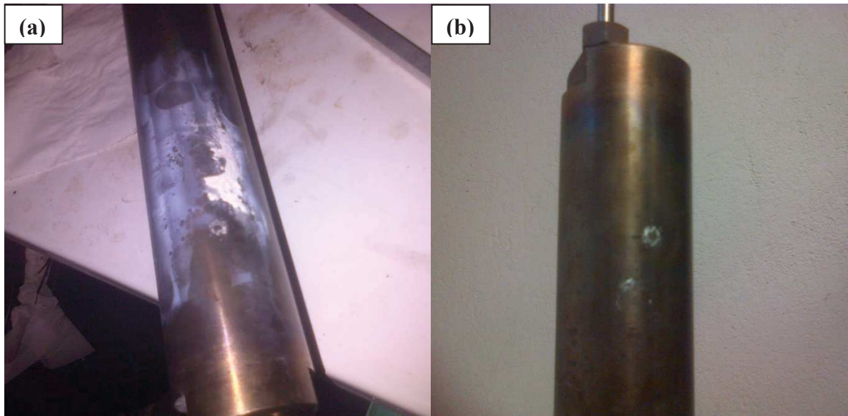
Figure III.20 : Dépôts salins sur l'autoclave avant nettoyage (a) et après nettoyage (b)
