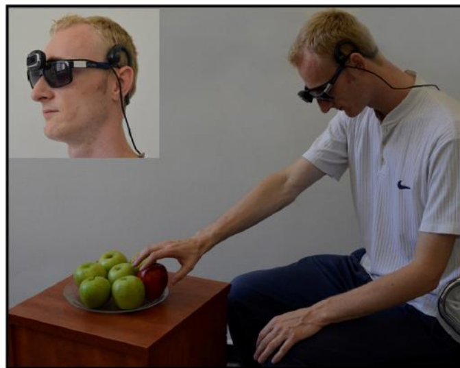
Figure 10. Dispositif de substitution sensorielle « EyeMusic ». L'utilisateur porte une caméra déportée sur une paire de lunettes, qui capture l'image colorée se trouvant face à lui. L'algorithme « EyeMusic » traduit alors les informations relatives à l'image en une combinaison de notes musicales, transmises via un casque audio (Levy-Tzedek et al. 2012).
