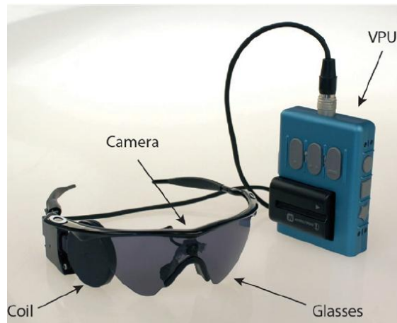
Figure 7. Éléments externes couplés à la prothèse rétinienne Argus II R . Il s'agit d'une monture de lunettes équipée d'une caméra, et d'un processeur vidéo (VPU) qui adapte le signal produit par la caméra aux caractéristiques de la grille de micro-électrodes fixée sur la rétine (Humayun et al. 2012).
