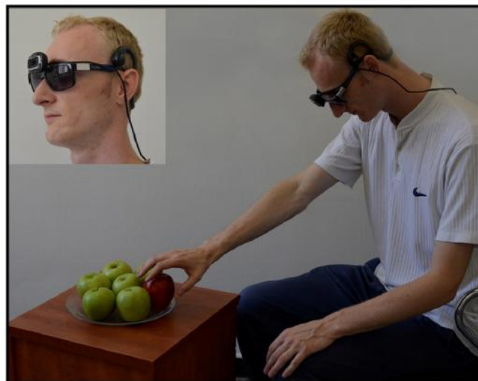
Figure 10. Dispositif de substitution sensorielle « EyeMusic ». L'utilisateur porte une caméra déportée sur une paire de lunettes, qui capture l'image colorée se trouvant face à lui. L'algorithme « EyeMusic » traduit alors les informations relatives à l'image en une combinaison de notes musicales, transmises via un casque audio (Levy-Tzedek et al. 2012).
