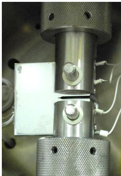
Figure 3 - 5 : Branchement pour une jauge de déformation sur la gauche, et branchement des câbles pour la mesure de la longueur de fissure par la méthode de différence de potentiel sur la droite
