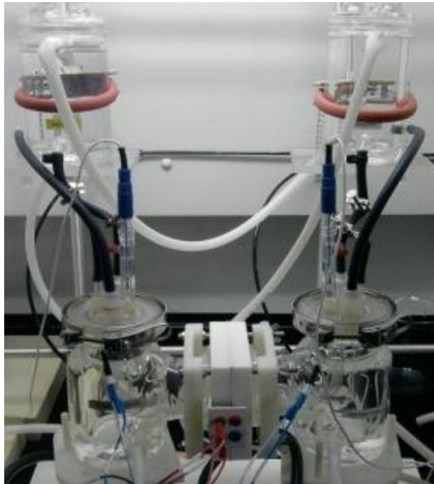
Figure 4 - 18 : Dispositif expérimental pour réaliser des mesures de perméation électrochimique [164]
