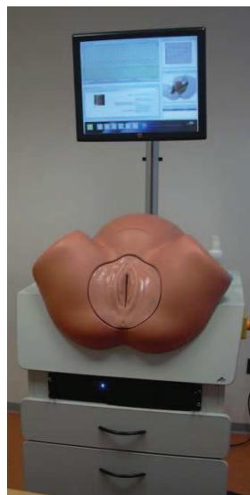
Figure 7 - Simulateur d'accouchement *SIMone*<sup>TM</sup>
