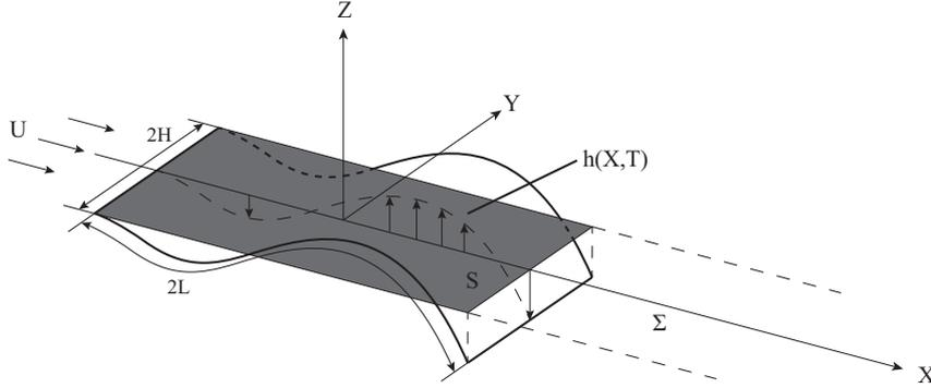
Figure 1 – Schéma du problème de la surface portante.
