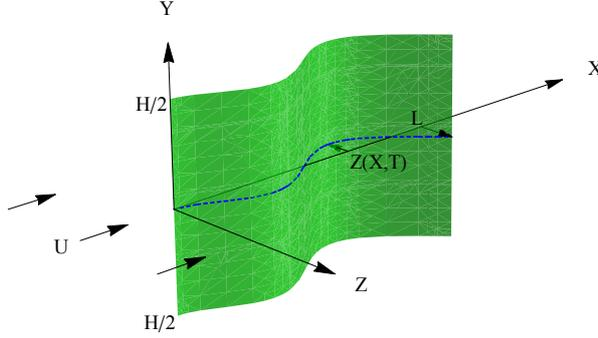
Figure 7 – Schématisation d'une plaque avec la 2D deflection  $Z(X,T)$  immergée dans un écoulement avec la vitesse  $U$ .
