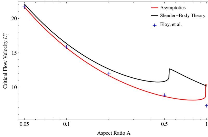
Figure 8 – Vitesse critique de l’écoulement en fonction du rapport d’aspect  $A$  pour une plaque de masse réduite  $M^* = 1$ . Les croix sont les résultats d’Eloy et al. [27]. Les courbes noire et rouge sont les résultats obtenus respectivement avec la théorie du corps élancé et le modèle proposé.
