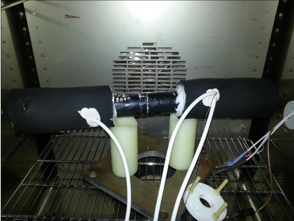
Figure 105 : montage expérimental et préparation du câble
