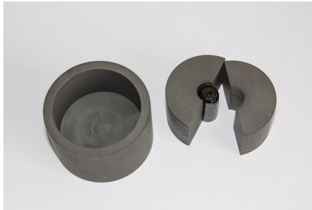
FIGURE 2.3: Démoulage du verre (ici MORB3) après l'étape de coulée dans le moule en graphite (crédits photographiques : Stéphanie Rossano).
