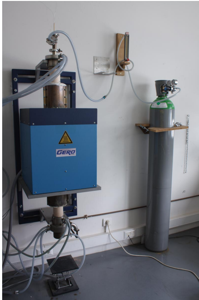
FIGURE 2.5: Four vertical du Laboratoire Géomatériaux et Environnement (Université Paris-Est Marne-la-Vallée) (crédits photographiques : Stéphanie Rossano).
