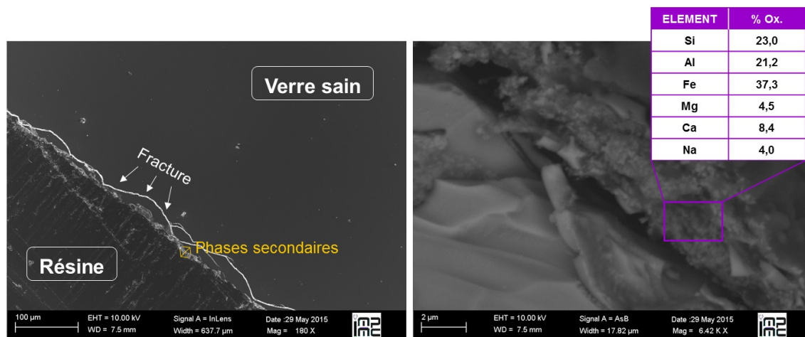
FIGURE 5.3: Images MEB (mode de détection d'électrons secondaire), de la coupe d'un verre MORB3 altéré 150 jours à 45°C au contact d'une solution d'AO et résultat d'une analyse semi-quantitative en EDS des phases observées.
