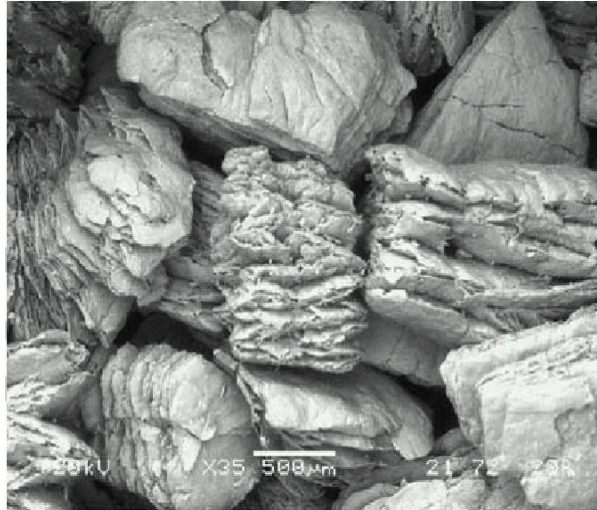
Photo I-2 : Micrographie MEB de la vermiculite
