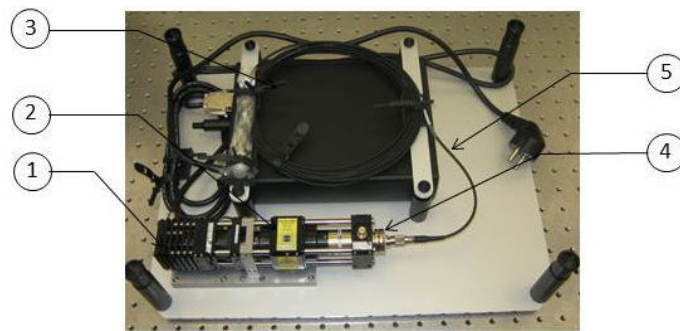
Figure 3.2. Le module diode laser utilisé pour la tête AFM avec : (1) Diode super-luminescente, (2) isolateur Faraday, (3) Contrôleur automatique de puissance, (4) coupleur de fibre optique, (5) fibre optique monomode de 6 m de longueur. Toutes les optiques sont intégrées dans le module.
