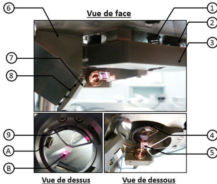
Figure 4.26. Assemblage des éléments du système de détection et des platines de réglage avec : (1) ressort de traction assurant le maintien et la stabilité de la platine de réglage, (2) extrémité de la butée micrométrique qui génère le déplacement, (3) pièce porteuse de la platine supportant l'ensemble prisme de renvoi/SLD, (4) objectif Mitutoyo Telecentric x10, (5) prisme de renvoi du spot laser vers le levier, (6) support des éléments de la platine de réglage du spot laser sur le bundle, (7) miroir de renvoi du spot laser sur la surface active du bundle, (8) support du miroir de renvoi suspendu à l'aide de ressorts de tractions, (9) support du prisme de renvoi à poutre encastées usinées par électroérosion, (A) diode SLD et (B) spot laser renvoyé vers le levier. Toutes les pièces mécaniques ont été réalisées en Invar pour assurer une bonne stabilité mécanique et thermique du système de détection [17].
