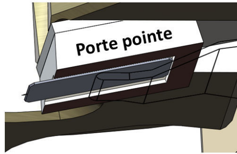
Figure 4.15. Le porte pointe supportant l'ensemble pointe/levier.
