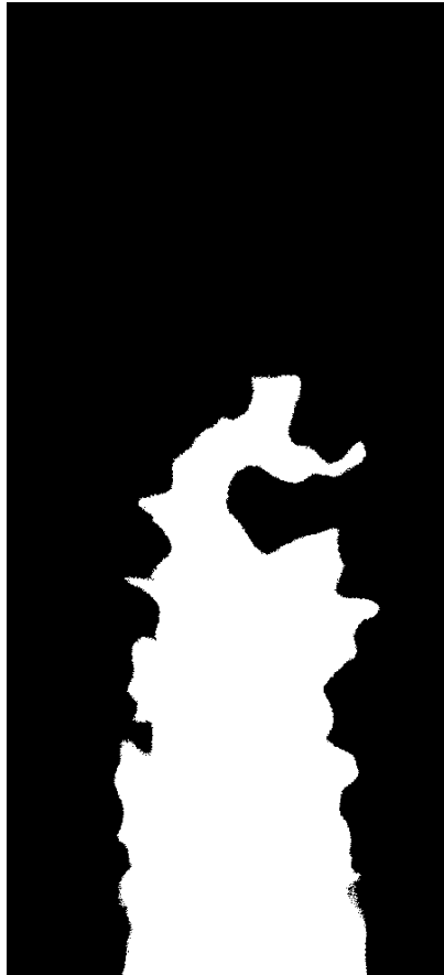
Figure 30 : Image binarisée d'une flamme méthane-air de richesse 0,7 à pression atmosphérique
