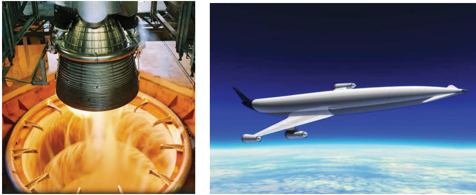
FIGURE 1.8 – Essais statique du moteur cryotechnique Vulcain équipant Ariane 5 . Illustration d'un avion du futur équipé de statoréacteurs pour des vols stratosphériques.
