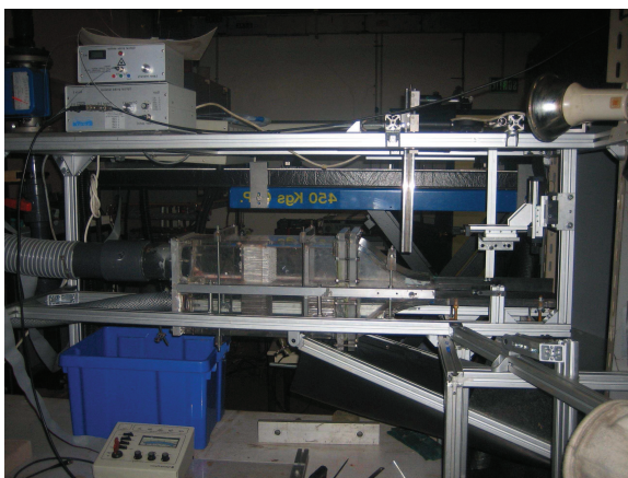
FIGURE 2.1 – Illustration du banc expérimental plan, à gauche, et profil de vitesse des deux phases à l'injection générée par ce banc, à droite.
