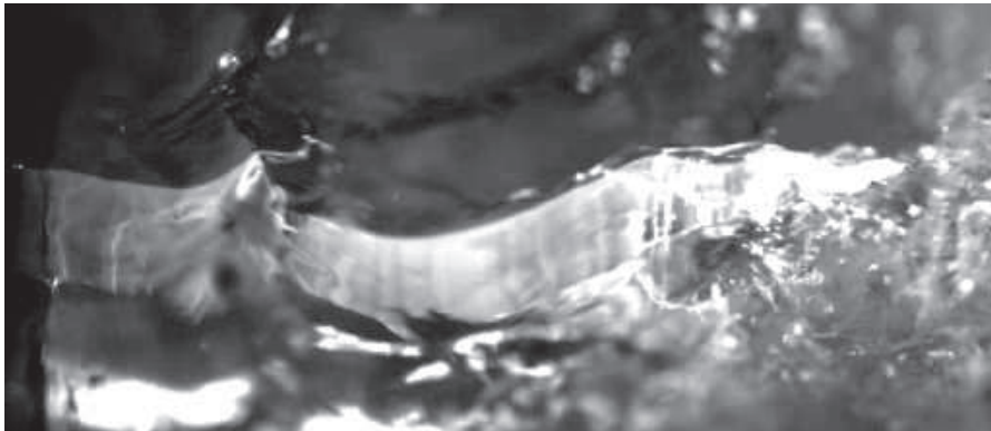
FIGURE 3.15 – Illustration d'une tranche de l'écoulement éclairé avec la méthode LIF et en lumière blanche
