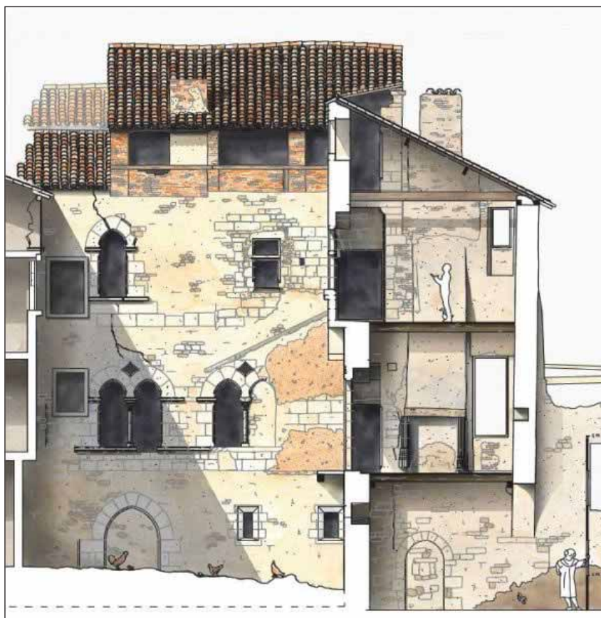
Fig. 64 : exemple de relevé réalisé dans le cadre de l'atelier de l'école de Chaillot en 2011, façade nord de la maison ID13
