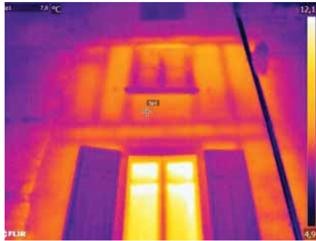
Maison ID231, rue de la Pélisserie Structure en pan-de-bois dissimulée sous le crépis au deuxième étage
