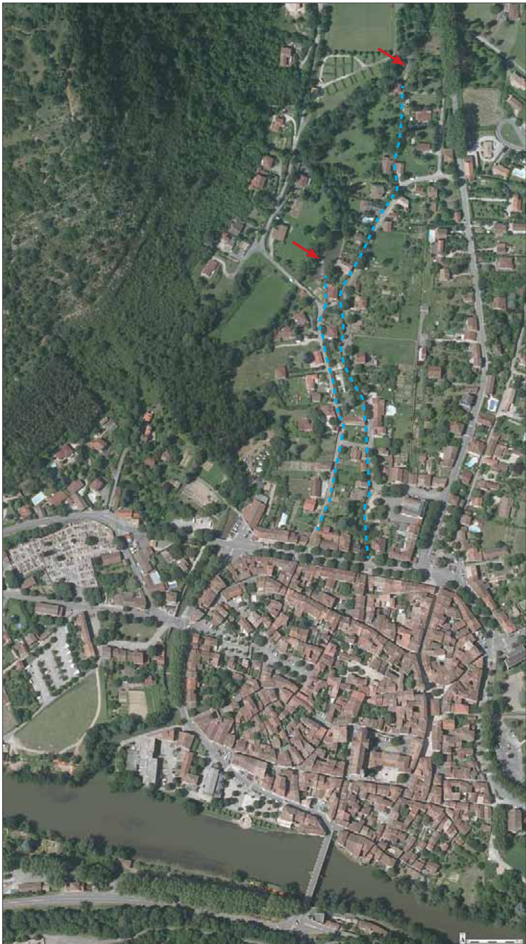
Fig. 382 : vue aérienne de Saint-Antonin et des dérivations hors les murs Les flèches rouges indiquent les prises d'eau des dérivations
