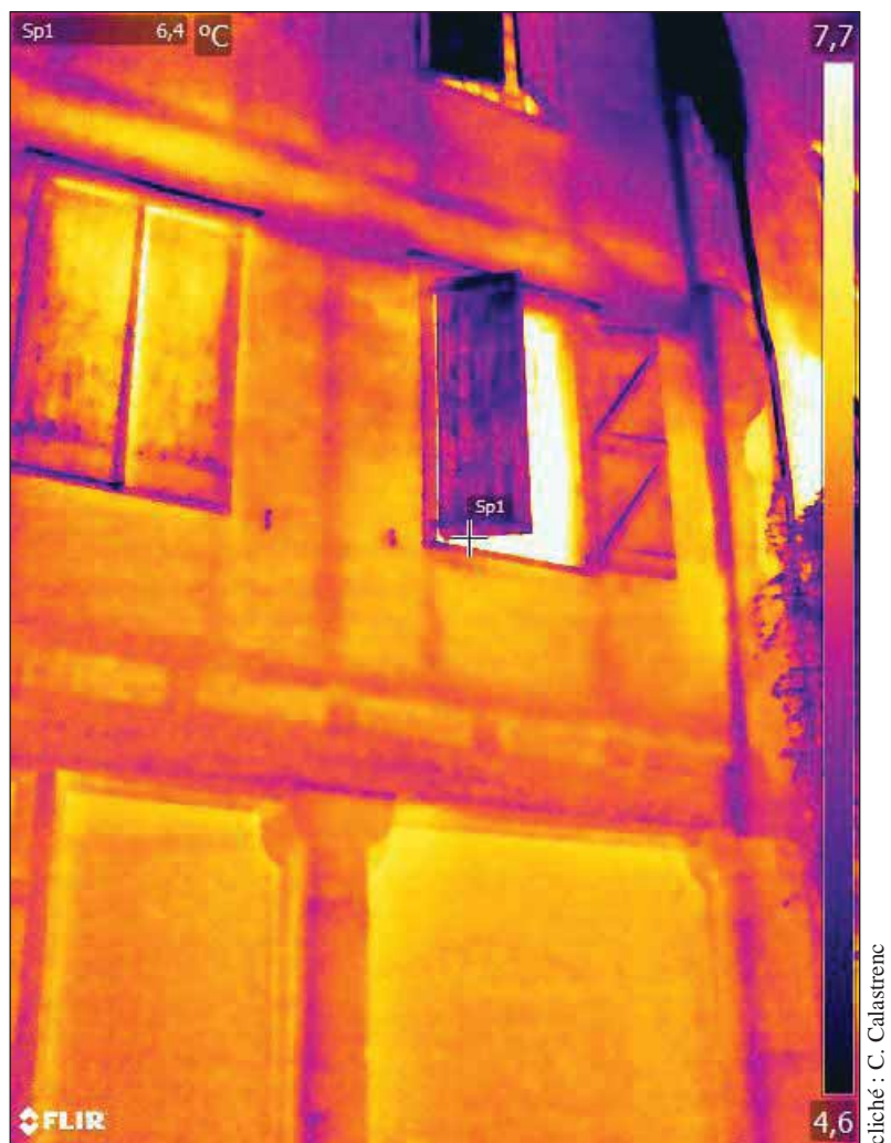
Fig. 4 : image thermique du pan-de-bois du premier étage
