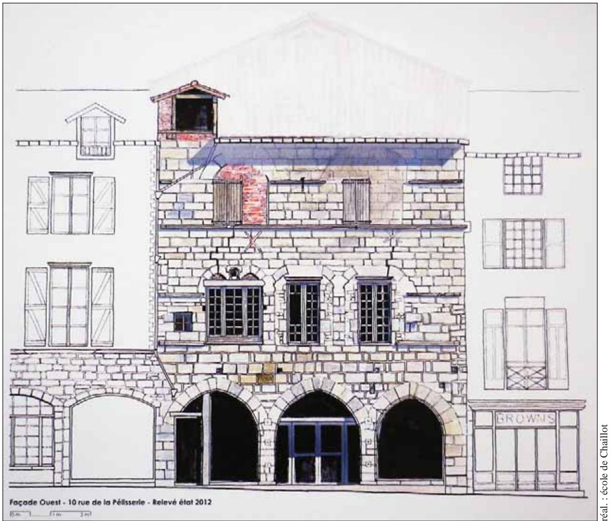
Fig. 3 : relevé de l'élévation sur la rue de la Pélisserie
