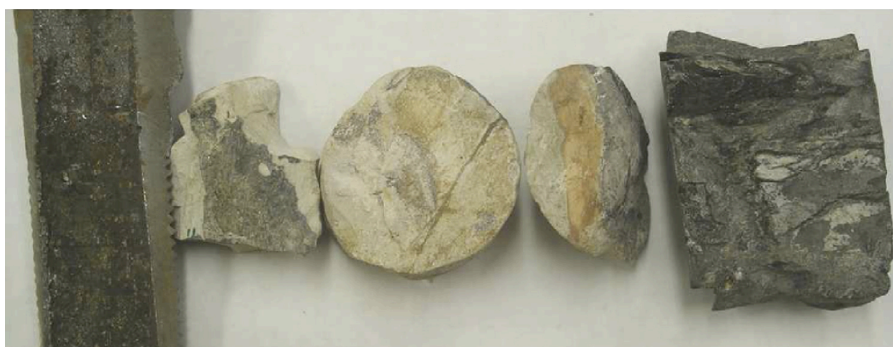
Fig 1.5. Photographie d'un échantillon provenant d'un puits abandonné montrant de gauche à droite, ciment avec une croûte noire de 1 mm altérée adjacente au tubage du puits, 5cm de ciment non altéré, ciment avec une zone d'altération de 1 cm en contact avec la roche, d'après Carey (2007) [39] .
