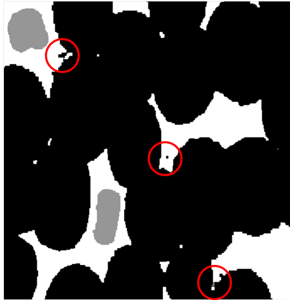
FIGURE 4.12 – Mise en évidence d’anomalies lors du seuillage de la micrographie optique d’une tranche de gaine sandwich
