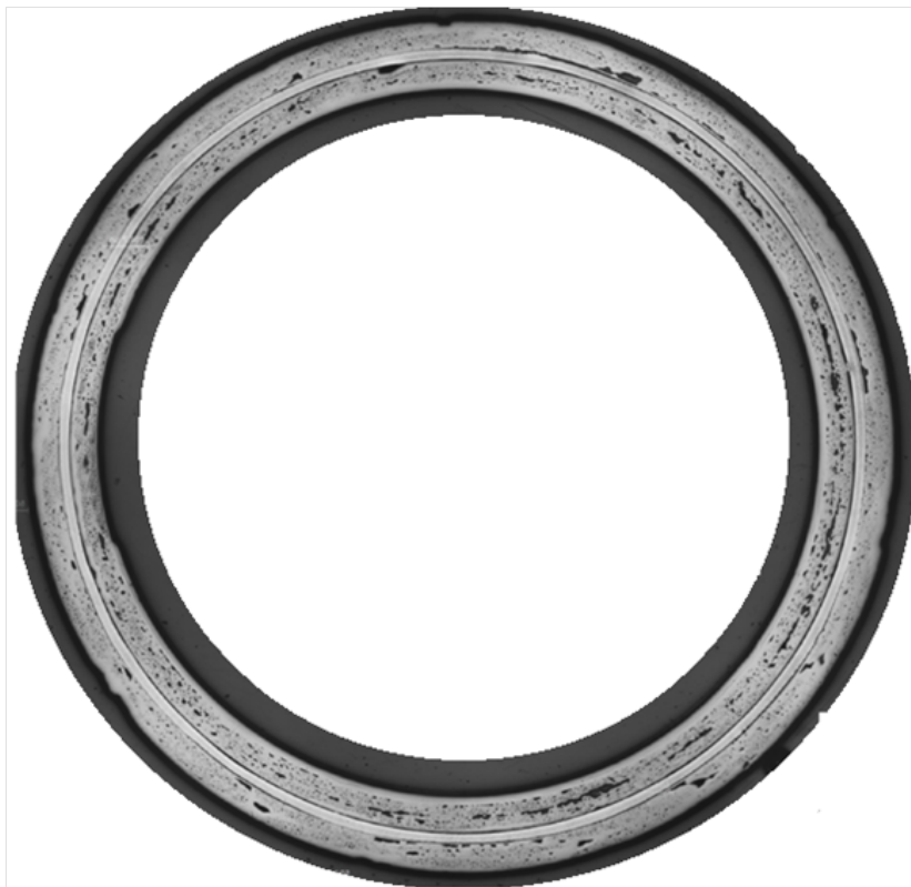
FIGURE 2.2 – Image reconstituée d'une section de la gaine « sandwich » CEA étudiée
