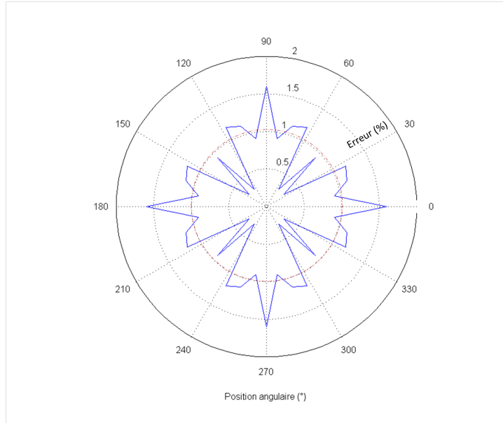
FIGURE 2.22 – Erreurs sur l'estimation par rapport à la position angulaire pour un tube de caoutchouc
