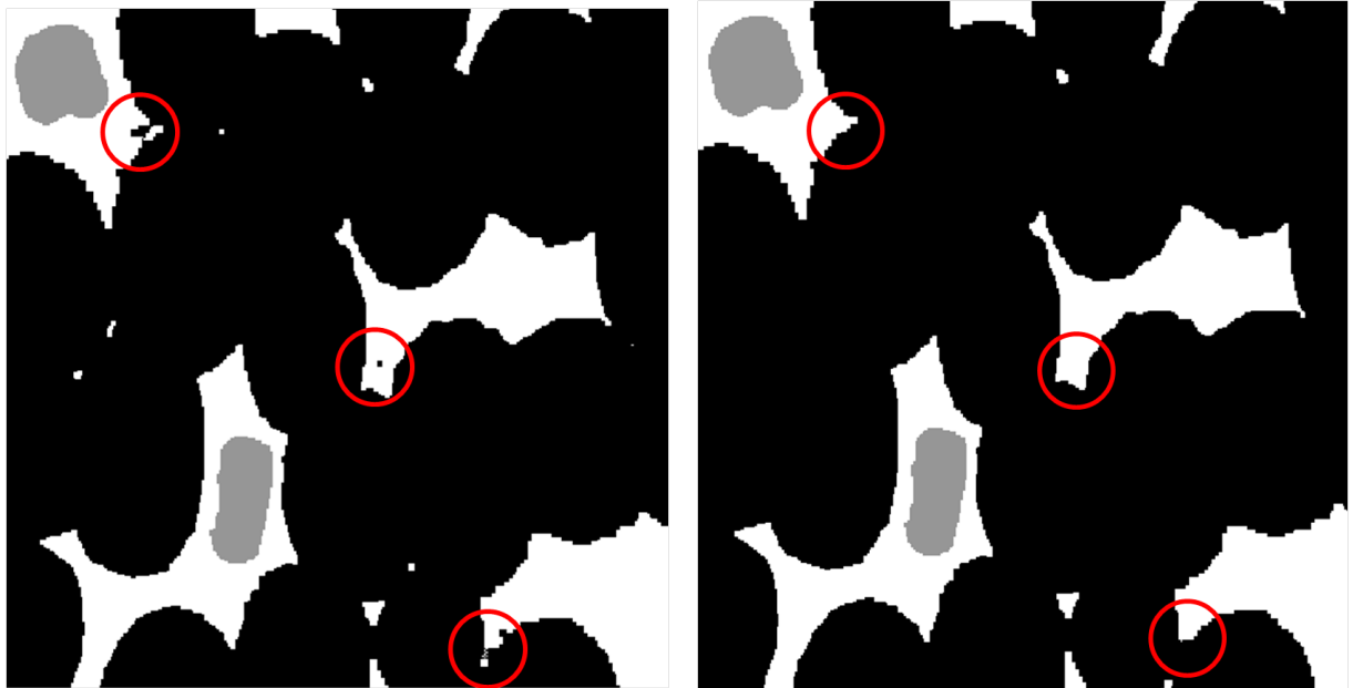
FIGURE 4.15 – Suppression des anomalies lors du seuillage de la micrographie optique d'une tranche de gaine sandwich
