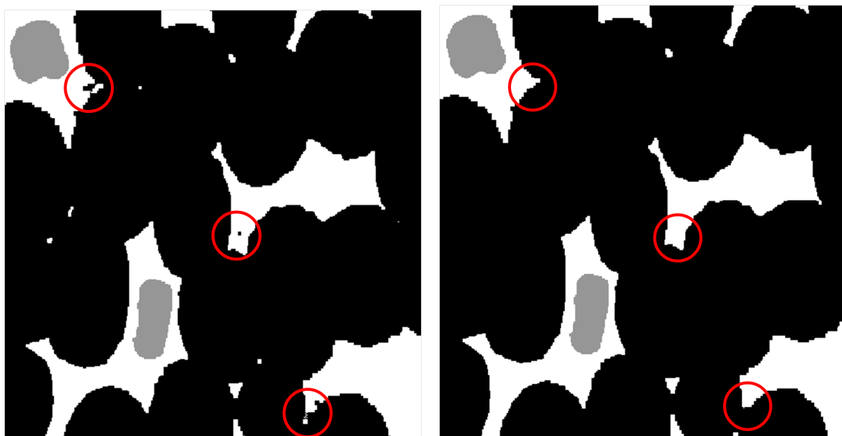
FIGURE 4.15 – Suppression des anomalies lors du seuillage de la micrographie optique d'une tranche de gaine sandwich
