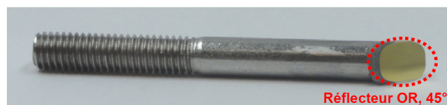
FIGURE 2.10 – Système réflecteur pour une mesure face arrière
