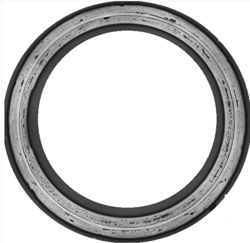
FIGURE 2.2 – Image reconstruite d’une section de la gaine « sandwich » CEA étudiée
