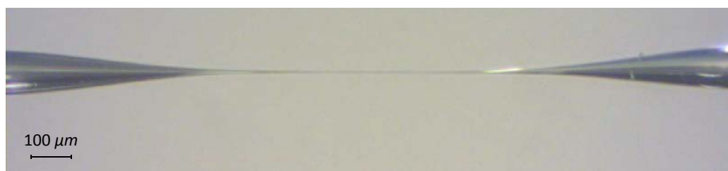
FIGURE 4.11 – Taper biconique fabriqué par fusion-étirage à l'aide d'une soudeuse de fibres optiques. La section amincie est inférieure à 2 \mu\text{m} sur environ 400 \mu\text{m} de long.
