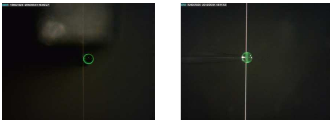
FIGURE 2.5 – Photographies de sphères en ZBLALiP dopées Erbium pompées à 1480 nm. Les sphères ont un diamètre de l'ordre de 100 \mu\text{m} .
