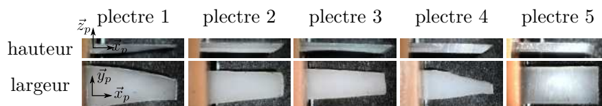
Fig. 5.9 Forme des plectres utilisés lors de l'expérience. Chaque photographie est en deux parties : celle du haut correspond à une vue de côté du plectre, celle du bas à une vue de dessus
