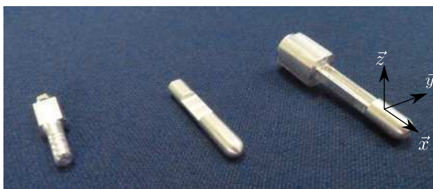
Fig. 3.11 Versions de l'effecteur de DRoPIC. De gauche à droite, on trouve l'effecteur original, puis la deuxième version, ne permettant la mesure d'effort que dans une direction et la version finale qui a été instrumentée.
