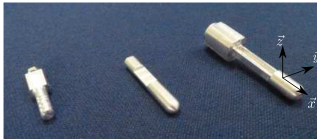
Fig. 3.11 Versions de l'effecteur de DRoPIC. De gauche à droite, on trouve l'effecteur original, puis la deuxième version, ne permettant la mesure d'effort que dans une direction et la version finale qui a été instrumentée.
