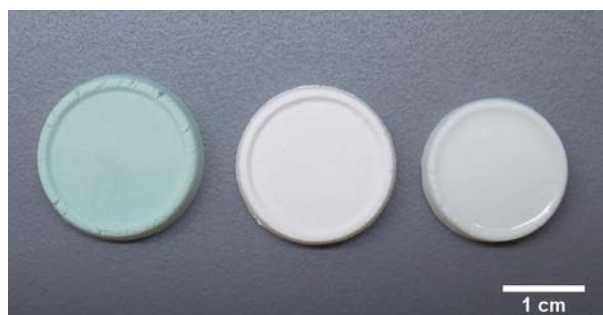
FIGURE 3.3 – Les différentes étapes de cuisson de la porcelaine : (de gauche à droite) porcelaine crue, porcelaine dégourdie et porcelaine cuite à maturation et émaillée.
