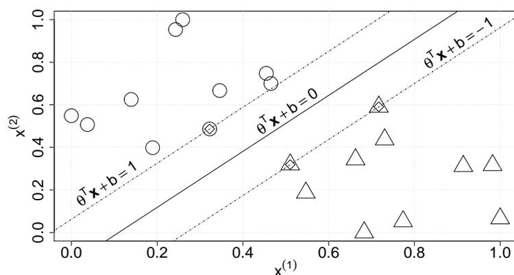
FIGURE B.6 : Exemples répartis selon 2 classes et séparés par un hyperplan à marges maximales
