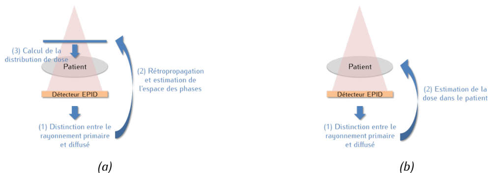
Figure 2-10 : Principe général de la rétropropagation de la dose à partir d'une image EPID en trois étapes.
