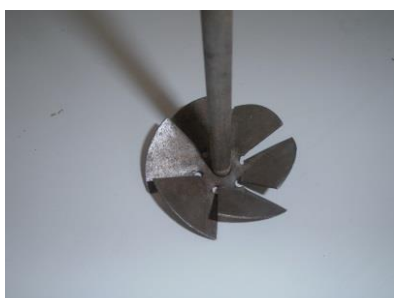
Figure 53: Hélice transversale utilisée pour émulsifier la liqueur noire
