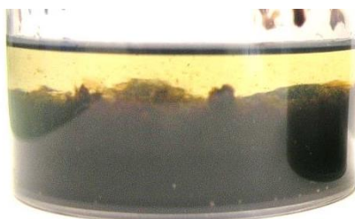
Figure 133: Signe d'émulsion instable: déphasage
