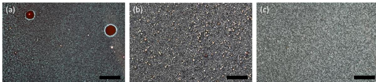
Figure V.9 : Images obtenues au microscope optique polarisé (polariseurs croisés) des films de (a) **TIPS-TPDO-oCN**, (b) **TIPS-TPDO-pCN**, (c) **TIPS-TPDO-4CN** déposés par voie liquide – La barre noire représente 50 nm
