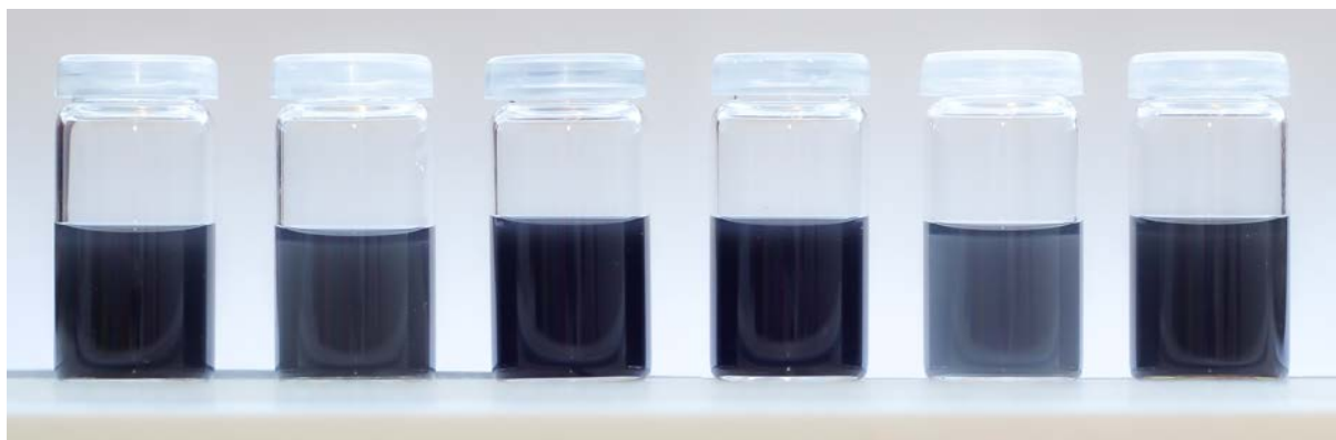
Figure 53 : Photographie des solutions d'adduit de graphène dans les différents solvants organiques (après filtration, lavage et redispersion). De gauche à droite : THF, Acétonitrile, NMP, DMF, Isopropanol, Toluène.
