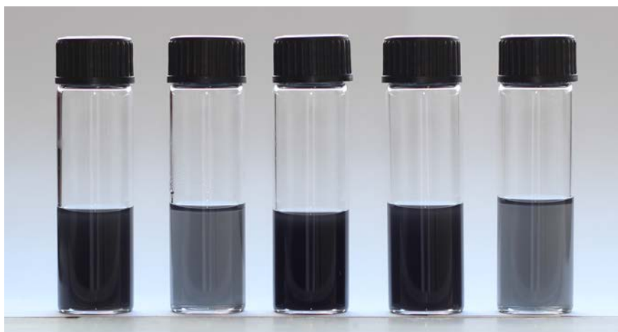
Figure 70 : Photographie des dispersions de graphène fonctionnalisé par les anthrones 3-7 (de gauche à droite) dans le THF (après filtration, lavage et redispersion dans le THF).
