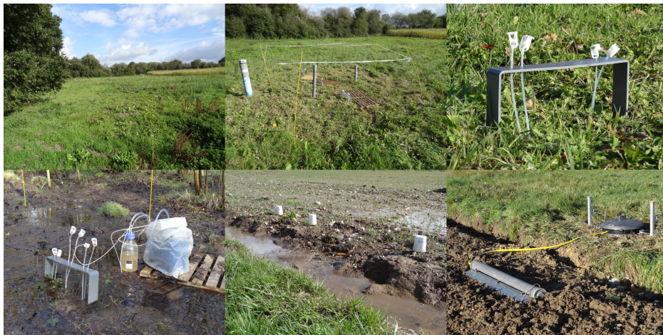
FIGURE 2.10 – Haut : bande enherbée de Guériniec ; piézomètres et pièges à eau en place ; piège à eau en place. Bas : prélèvement dans un piège à eau ; mini-piézomètre à l'interface entre la parcelle et la bande enherbée de Guériniec ; dispositif de collecte des eaux de ruissèlement.
