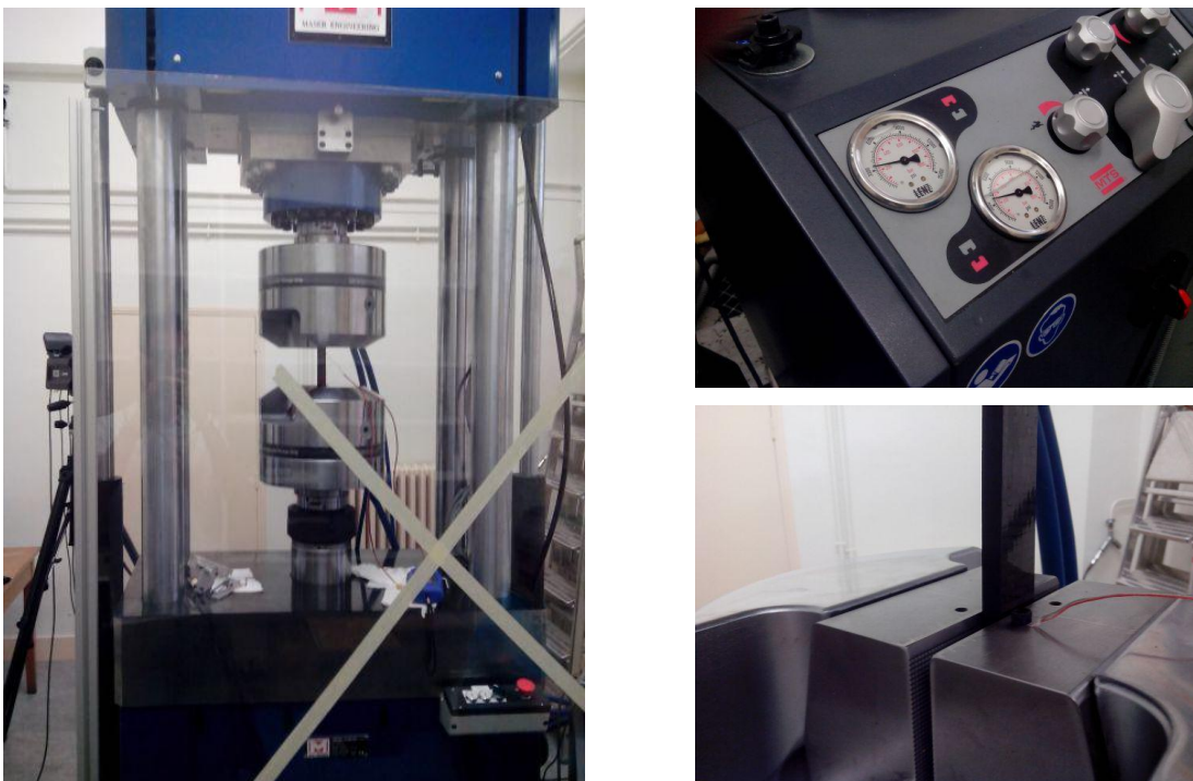
Figure 3.14 - Machine d'essai Maser 550 kN avec détails du serrage d'une éprouvette par un mors.
