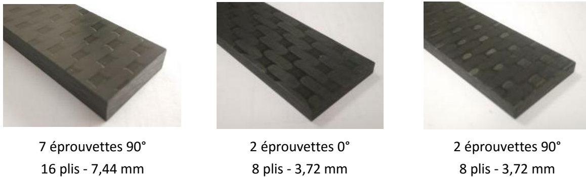
Figure 3.8 - Les trois configurations d'éprouvettes testées
