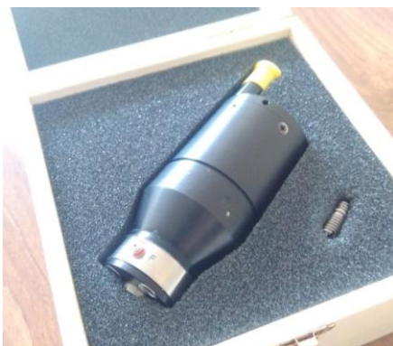
Figure 2.12 - Excitateur piezoshaker Wilcoxon Meggit F7.
