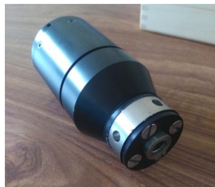
Figure 2.12 - Excitateur piezoshaker Wilcoxon Meggit F7.
