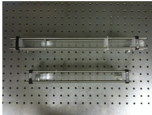
FIGURE 3.43 – Photographie des deux guides fonctionnant autour de 0,5 THz, un premier de 40 cm de long (au-dessus) et un deuxième de 35 cm de long (en-dessous).
