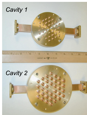
FIGURE 3.2 – Photographie de résonateurs à cristal BIP 2D métallique dans le plan étudiés par E. I. Smirnova et al. [98].
