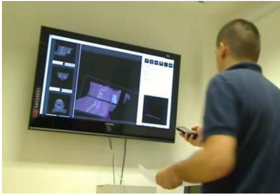
Figure 58 : Utilisation des accéléromètres du smartphone pour manipuler des données médicales 3D (de Souza et al. 2010)
