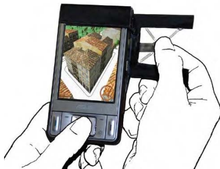
Figure 46 : Contrôle de la navigation avec un objet physique élastique à côté du smartphone (Hachet, Pouderoux, and Guitton 2008)
