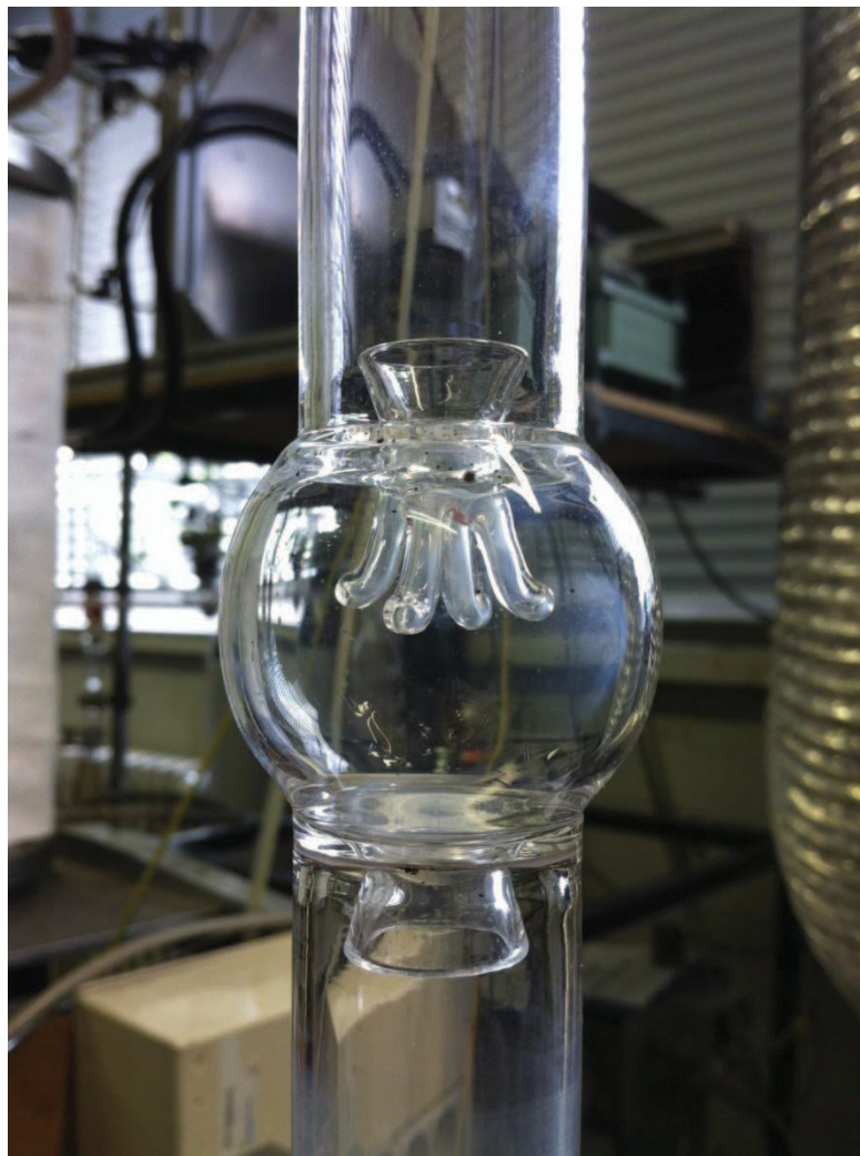
Figure III.1 : Le réacteur auto-agité par jets gazeux (JSR)
