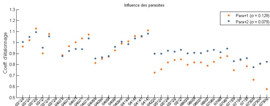
**FIGURE 4.14** Coefficients d'étalonnage PTU calculés en comparant la donnée PTU1 avec la moyenne du profil lidar sur une couche d'épaisseur 67,5 m démarrant à une distance telle que le RSB soit supérieur à 10 et en prenant en compte (points gris) ou non (points oranges) l'influence des parasites
