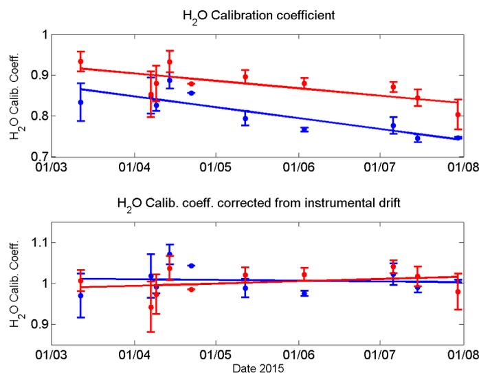
**FIGURE 4.22** Coefficients d'étalonnage PTU (*rouge*) et ZWD (*bleu*) obtenus durant la campagne à Saint-Mandé. Un point par nuit, la barre d'erreur correspondant à l'écart-type sur la nuit. Sur le graphe inférieur les coefficients ont été corrigés de la dérive des calibrations N<sub>2</sub>.
