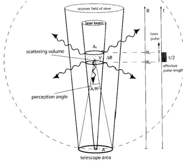
FIGURE 1.2 Illustration de l'équation lidar (Wandinger, 2005a)
