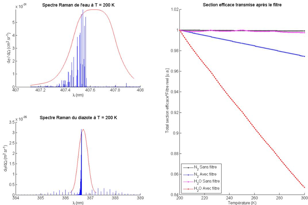
**FIGURE 3.4** Spectres Raman de la vapeur d'eau (branche Q, *en haut à gauche*) et du diazote (branches OQS, *en bas à droite*) et filtres interférentiels Barr à incidence normale (largeur à mi hauteur de 0,38 nm pour la vapeur d'eau et de 0,44 nm pour l'azote). *À droite*, Variations relative de la section efficace transmise au récepteur avec et sans filtre.
