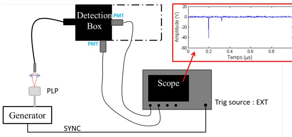
**FIGURE 3.34** Dispositif pour l'étude des afterpulses. Le laser (*Picosecond Light Pulser, PLP*, Hamamatsu) émet des impulsions à une fréquence déterminée par l'utilisateur par le biais du générateur. Ces impulsions sont envoyées via la fibre au boîtier de détection. Les signaux des PMT sont enregistrés sur l'oscilloscope puis transférés pour traitement sur un PC. Un exemple d'impulsion laser vue par les PMT est montré dans l'encadré rouge.
