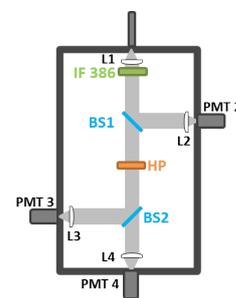
**FIGURE 1.13** Boitier de détection en configuration "Calibration  $N_2$ "
