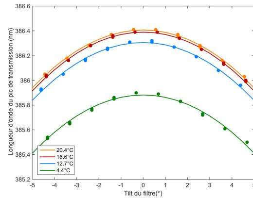
**FIGURE 3.11** Longueur d'onde du maximum de transmission à travers un filtre Barr étroit centré en  $386,71$  nm en fonction du tilt pour différentes températures. Les points correspondent aux données expérimentales que l'on ajuste par moindres carrés à une parabole.
