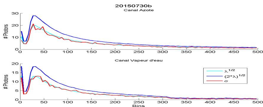
**FIGURE 3.49** Vérification de la loi de Poisson sur un profil de vapeur d'eau à Saint-Mandé - Discriminants 15 pour H<sub>2</sub>O et 20 pour N<sub>2</sub>
