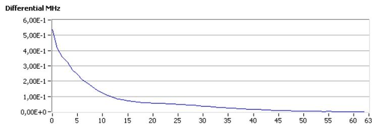
FIGURE 3.45 Pulse Height Distribution (en différentiel) du PMT H<sub>2</sub>O
