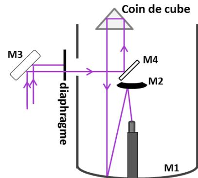
FIGURE 1.9 Réglage au coin de cube
