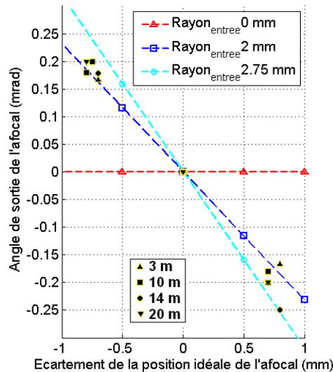
FIGURE 1.8 Courbes théoriques et points expérimentaux du protocole de réglage de l'afocal
