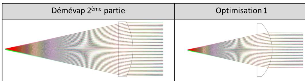
**FIGURE 3.21** Simulation de l'arrivée du faisceau sur la première lentille du boîtier (Zemax) Pour une fibre de 0,4 mm. À droite pendant la deuxième partie de Démévap, focale = 46 mm, À gauche pour l'optimisation 1, focale = 40 mm.
