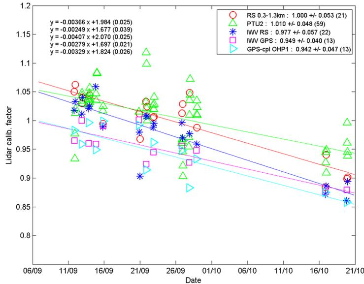
**FIGURE 2.1** Évolution du coefficient d'étalonnage durant Démévap pour différentes méthodes d'étalonnage. (○) Comparaison avec une couche de radiosondage (△) Comparaison avec donnée du PTU (\*) CIVE du radiosondage (□) CIVE du GPS (▷) Couplage lidar-GPS
