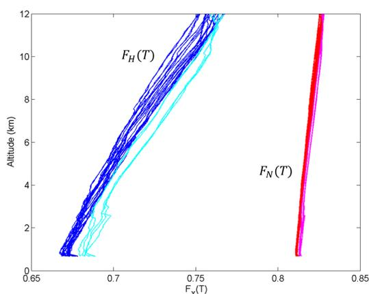
**FIGURE 3.5** Fonctions de dépendance en température des profils de vapeur d'eau enregistrés durant la campagne Démévap. En bleu(septembre)/cyan(octobre) pour le canal vapeur d'eau, et en rouge(septembre)/magenta(octobre) pour le canal azote
