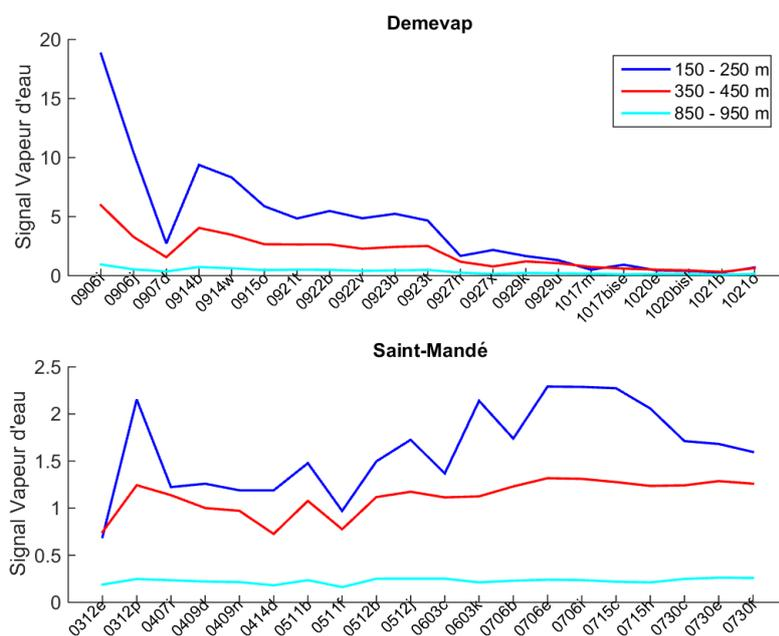
**FIGURE 4.12** Évolution du signal absolu Raman du canal vapeur d'eau des calibrations N<sub>2</sub> sur différentes couches pour les deux campagnes de mesures (en  $\text{ph}\cdot\text{bin}^{-1}\cdot\text{tir}^{-1}$ ). *Haut* : Démévap / *Bas* : Saint-Mandé
