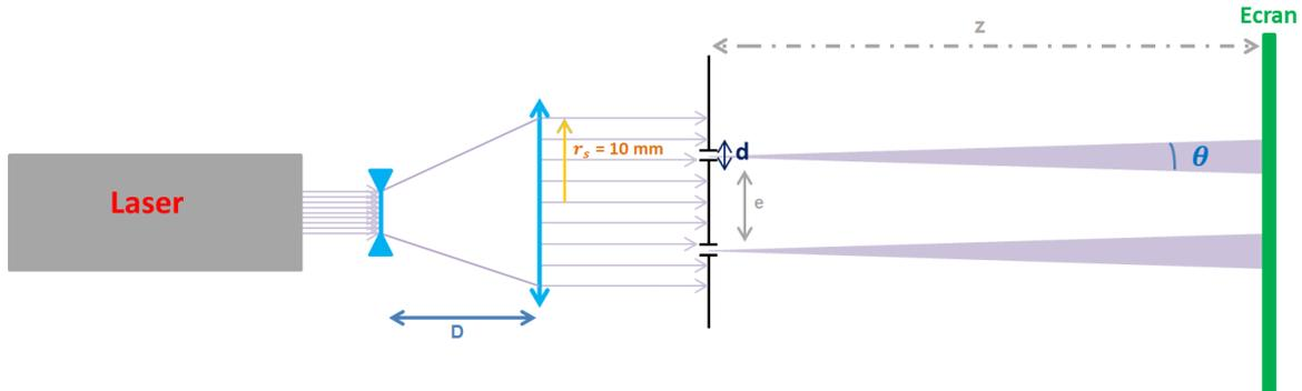
**FIGURE 1.7** Dispositif expérimental pour le réglage de l'afocal
