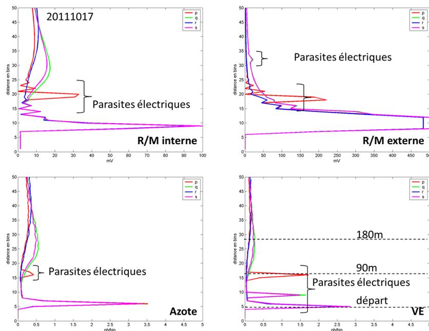
**FIGURE 2.3** Exemple des parasites observés sur les quatre canaux, pour des profils *en visée oblique* durant Démévap. *De gauche à droite et de haut en bas* : Rayleigh/Mie interne, Rayleigh/Mie externe, Raman Azote, Raman vapeur d'eau. On notera en particulier la présence du parasite à 90 m sur le canal vapeur d'eau, distance à laquelle se trouve le PTU 1.
