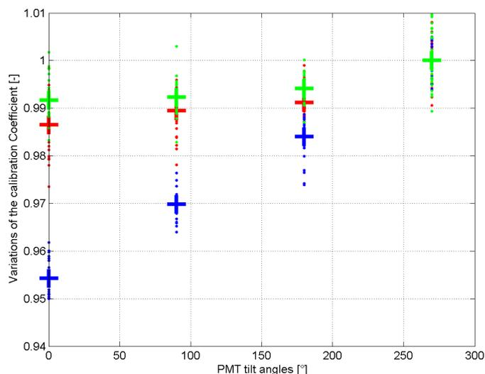
**FIGURE 3.25** Variations du ratio des signaux des deux canaux Raman pour différentes positions du PMT. *Bleu* Configuration de Démévap (0,8 mm/grand boitier). *Vert* Optimisation 1 (0,4 mm/grand boitier). *Rouge* Optimisation 2 (1 mm/boitier court)
