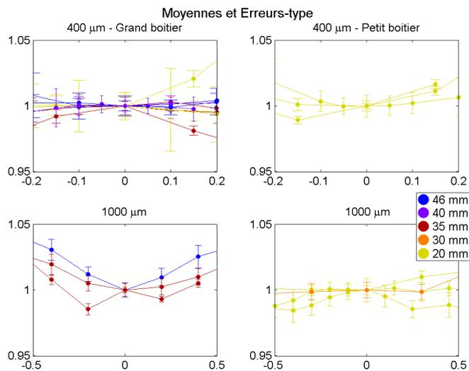
**FIGURE 3.27** Test de translation du spot lumineux sur l'entrée de la fibre, pour 2 types de fibres (400/1000  $\mu\text{m}$  - haut/bas), 2 tailles de boîtiers (Long/court - Gauche/droite) et différentes lentilles (couleurs)
