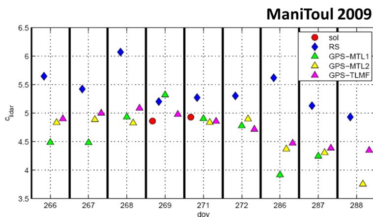
**FIGURE 1.15** Constantes d'étalonnage calculées durant la campagne MANITOUL en 2009. Chaque section du graphe correspond à une nuit de mesure. Trois techniques d'étalonnages sont présentées ici : ajustement avec une couche d'un radiosondage ( $\diamond$ ), ajustement avec une données de capteur d'humidité placé au sol ( $\circ$ ) ou couplage lidar et GPS ( $\triangle$ ).
