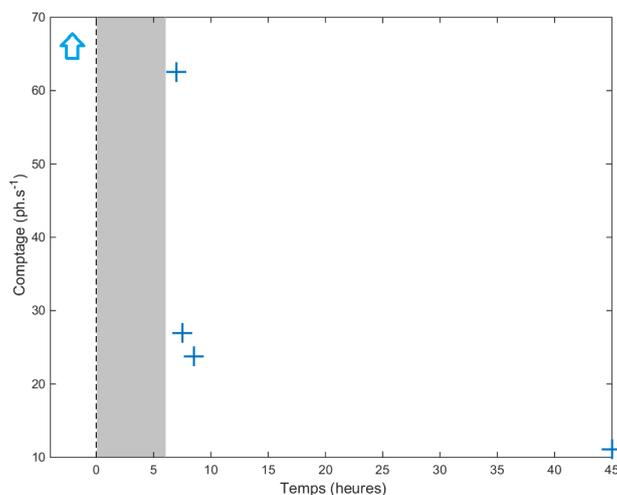
**FIGURE 3.38** Diminution du comptage d'obscurité après sur-exposition du PMT N<sub>2</sub>.
