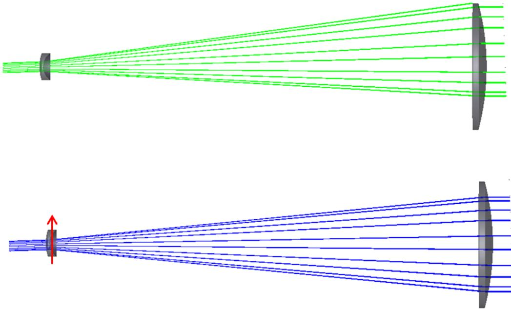
**FIGURE 1.10** Schéma Zemax de l'afocal et compensation d'un tilt du faisceau par la translation de la première lentille. *Haut* Faisceau tilté qui ressort en étant coupé par la deuxième lentille. *Bas* Translation de la première lentille pour compenser l'effet du tilt.
