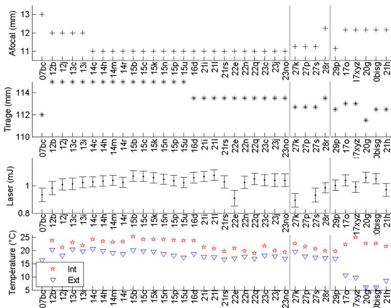
**FIGURE 2.5** Évolution des réglages de l'afocal et du tirage de la fibre dans le télescope ainsi que de l'énergie laser et de la température dans le camion et à l'extérieur durant la campagne Démévap. L'axe des abscisses n'est pas linéaire, les séries sont données dans l'ordre où elles ont été enregistrées.
