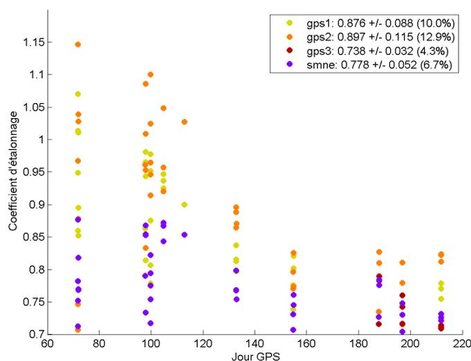
**FIGURE 4.19** Variations temporelles du coefficient d'étalonnage lidar, calculé par comparaison avec le ZWD des différents GPS (1, 2, 3 et SMNE). Le complément basse couche au profil lidar est calculé à partir des données RS de Trappes, et le complément hautes couches est d'une part calculé avec le RS de Trappes de 5 à 15 km puis au delà avec un modèle empirique.
