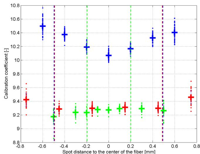
**FIGURE 3.29** Variations du coefficient d'étalonnage enregistrées lors du test de translation d'un spot le long de l'entrée de la fibre pour trois configurations optiques. Les traits en pointillés marquent les limites de la fibre. (*bleu*) Configuration non optimisée de Démévap (*vert*) Configuration optimisée 1 boîtier long/petite fibre 0,4 mm (*rouge*) Configuration optimisée 2 boîtier court/large fibre 1 mm
