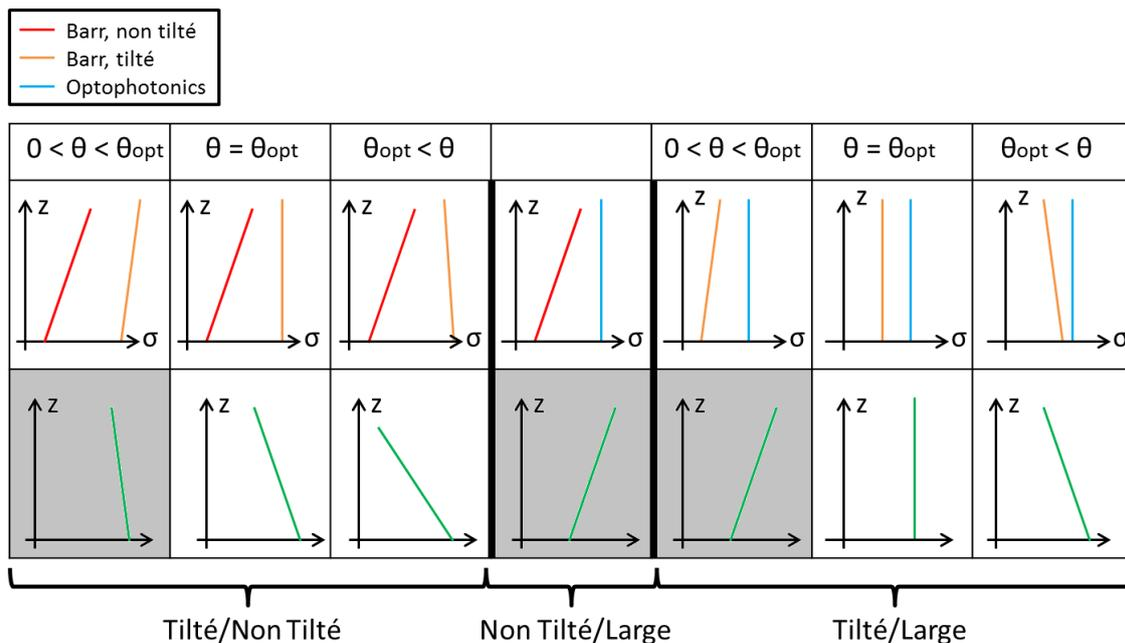
**FIGURE 3.13** Courbes des sections efficaces pour les différentes options de filtres (1ère ligne) et allures des rapports attendus des profils (2nde ligne). Les trois premières colonnes font référence à la comparaison des profils avec le filtre étroit tilté et non tilté, la quatrième colonne illustre la comparaison des profils avec le filtre large et le filtre étroit, et les trois dernières colonnes sont associées aux profils réalisés avec les filtres large et étroit tilté.
