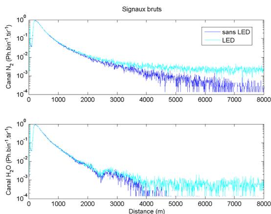
**FIGURE 4.4** Signaux moyens des canaux Raman niveau 0. *Cyan* : Ajout d'un signal constant issu d'une LED bleue
