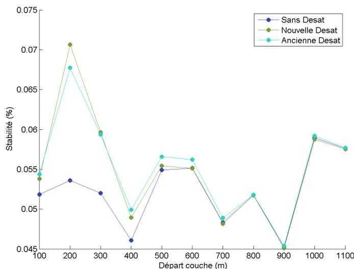
**FIGURE 4.8** Stabilité des séries temporelles de Calibration  $N_2$  en fonction de l'altitude pour les trois versions de traitement de la saturation. La stabilité est calculée à partir de la moyenne du ration des signaux Raman sur une couche d'épaisseur 100 m.
