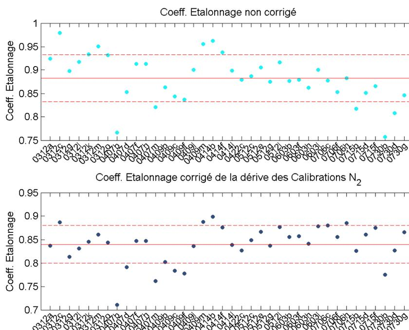
**FIGURE 4.16** Coefficients d'étalonnage du lidar par rapport aux capteurs PTU, pour la méthode donnant la meilleure stabilité du coefficient d'étalonnage. (*Haut* :) données non corrigées. (*Bas* :) données corrigées des calibrations  $N_2$
