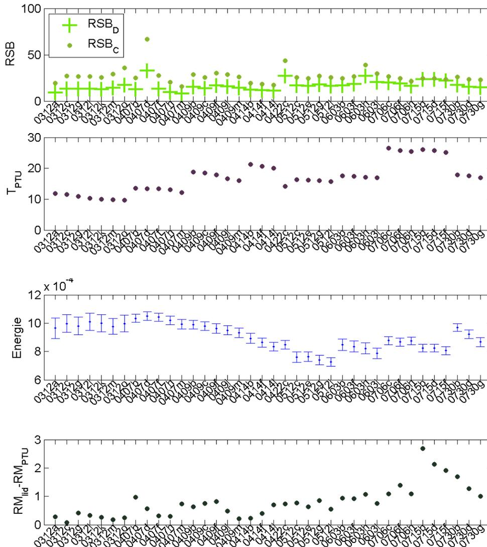
**FIGURE D.7** 1) RSB sur le canal azote (C) et vapeur d'eau (D), 2) Température moyenne au niveau du PTU, 3) Énergie du laser, 4) Différence entre le rapport de mélange du lidar non corrigé et le rapport de mélange du PTU
