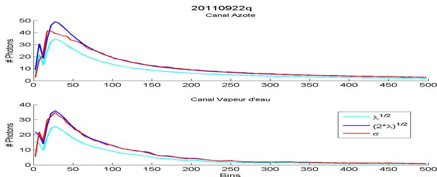
**FIGURE 3.47** Vérification de la loi de Poisson sur un profil de vapeur d'eau durant Démévap - Discriminants 5 sur les deux canaux Raman. *Cyan* Racine carrée de la moyenne du nombre de photons. *Bleu* Racine carrée de deux fois la moyenne du nombre de photons. *Rouge* Écart-type observé
