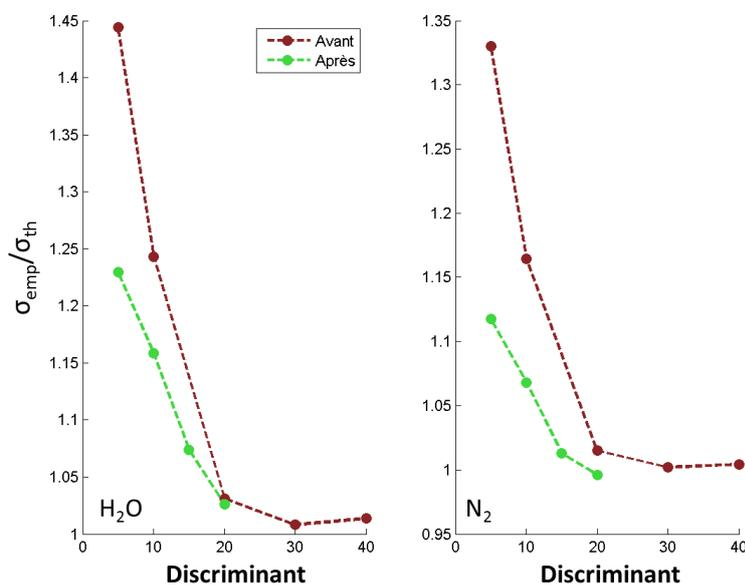
**FIGURE 3.46** Rapport de l'écart-type empirique ( $\sigma_{emp}$ ) sur l'écart-type théorique ( $\sigma_{th} = \lambda$ ) en fonction du discriminant pour les deux PMT (*gauche* : H<sub>2</sub>O, *droite* : N<sub>2</sub>). La courbe rouge correspond au Licel avant la révision et la courbe verte à après la révision.
