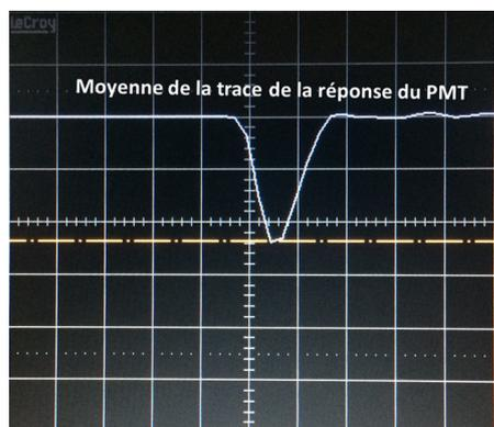
**FIGURE 3.35** Amplitude moyenne du photon unique (abscisses : 5 ns.div<sup>-1</sup>/ordonnées : 5 mV.div<sup>-1</sup>)
