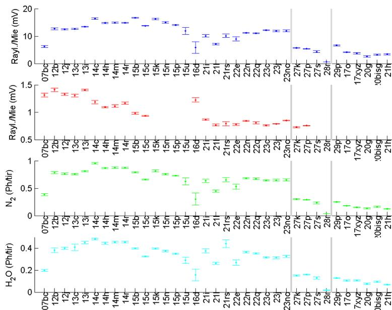
**FIGURE 2.4** Évolution des signaux corrigés des quatre canaux du lidar IGN durant la campagne Démévap, sur la couche d'altitude 317-1317 m. L'axe des abscisses n'est pas linéaire, les séries sont données dans l'ordre où elles ont été enregistrées. De haut en bas : Rayleigh/Mie interne, Rayleigh/Mie externe, Raman Azote et Raman Vapeur d'eau.
