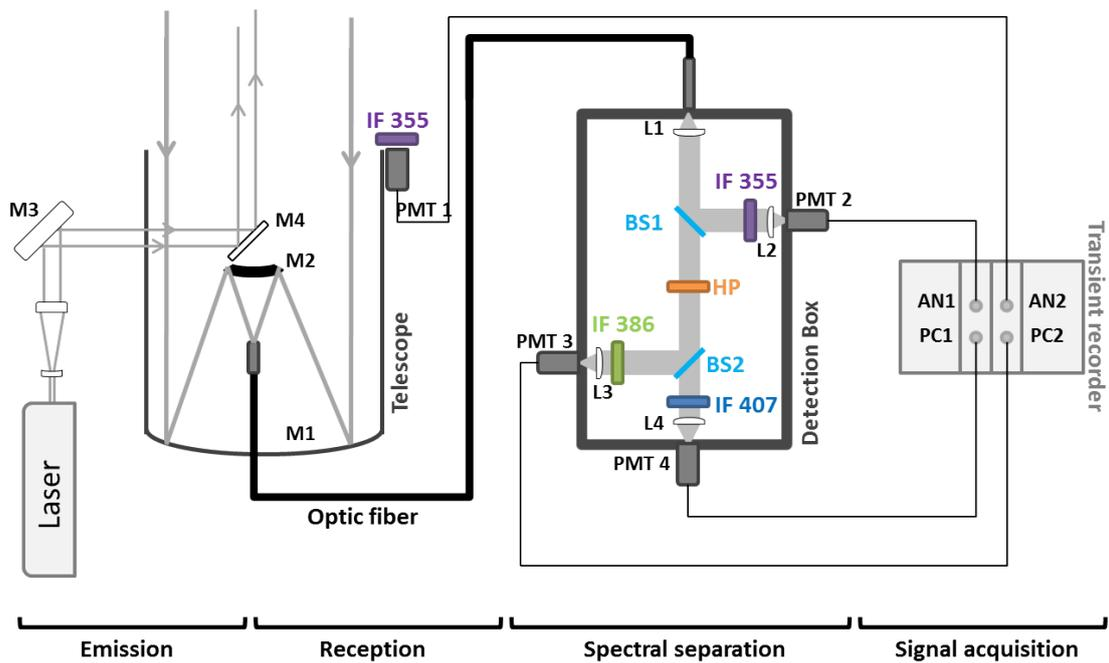
**FIGURE 1.4** Schéma général du lidar Raman de l'IGN ( $M1$  Miroir primaire du télescope,  $M2$  miroir secondaire du télescope,  $M3$  et  $M4$  miroirs de renvoi,  $IF$  filtres interférentiels,  $BS$  lames séparatrices,  $HP$  filtre passe-haut,  $L1/L2/L3/L4$  lentilles,  $AN$  entrée en mode analogique,  $PC$  entrée en mode comptage de photons)
