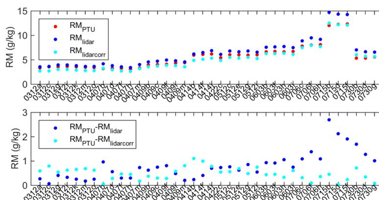
**FIGURE 4.17** *Haut* Évolution des rapports de mélange du PTU, du lidar (moyenné sur une couche) et du lidar corrigé des coefficients des "Calibrations N<sub>2</sub>". *Bas* Évolution de la différence des rapports de mélange du PTU par rapport au lidar corrigé et non corrigé des "Calibrations N<sub>2</sub>"
