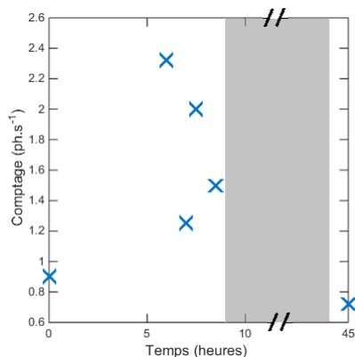
**FIGURE 3.36** Variation du courant d'obscurité en fonction du temps pour le PMT H<sub>2</sub>O. La zone rouge correspond à un arrêt de l'alimentation du PMT
