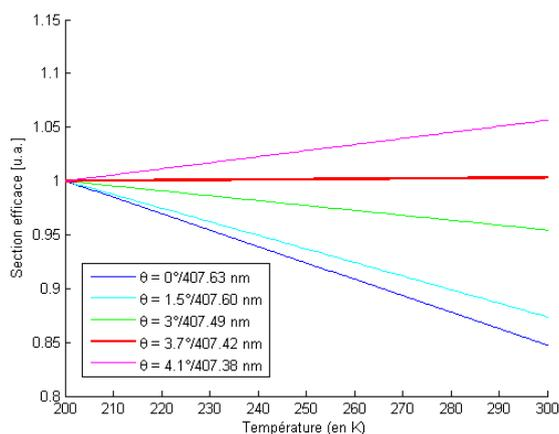
**FIGURE 3.12** Variations relatives de la section efficace de la vapeur d'eau en fonction de la température, pour différents tilts du filtre. On donne entre parenthèse la longueur d'onde centrale correspondante.
