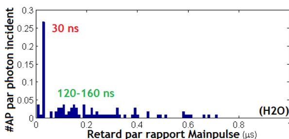
**FIGURE 3.41** Diagramme des fréquences d'afterpulses en fonction du retard par rapport au pulse principal. Les données sont normalisées par rapport au nombres de photons dans le pulse principal, seul les pulses engendrant des afterpulses sont pris en compte.
