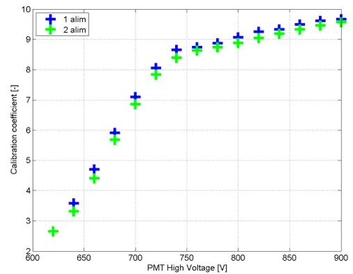
**FIGURE 3.51** Variation du coefficient d'étalonnage en fonction de la tension d'alimentation des PMT
