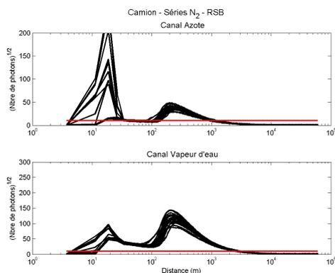
**FIGURE 4.9** Profils de RSB (*haut* Canal Azote/*bas* Canal Vapeur d'eau) des enregistrements de Calibration N<sub>2</sub> lors de la campagne à Saint-Mandé
