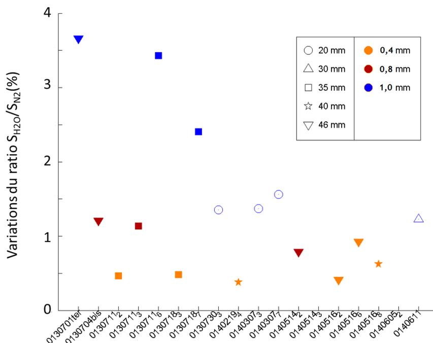
**FIGURE 3.28** Variations relatives au test de translation du spot lumineux sur l'entrée de la fibre, pour différentes configurations optiques. *Symboles* : focale de la lentille L1, *Couleurs* : diamètre de la fibre, *Remplissage* : taille de boîtier (plein : long/vide : court)
