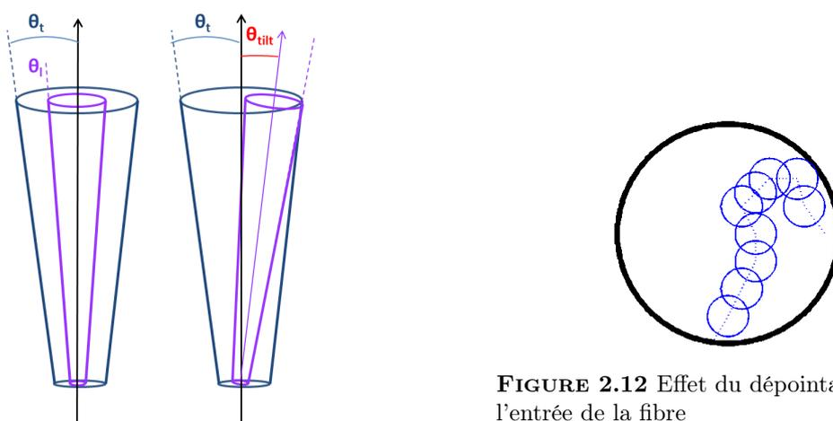
**FIGURE 2.11** Tilt de l'axe du faisceau laser par rapport à l'axe optique du télescope
