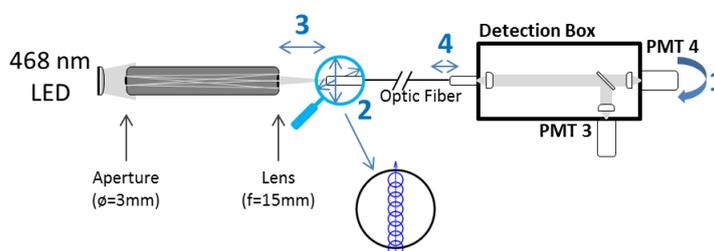
**FIGURE 3.23** Dispositif expérimental d'étude des instabilités du boîtier de détection. (1) Rotation des PMT pour d'étude de l'inhomogénéité de la photocathode (2) Translation du spot sur l'entrée de la fibre pour l'étude de la dérive du faisceau laser (3) Variation de la taille du spot sur l'entrée de la fibre (4) Variation de l'écartement entre la fibre et la première lentille (L1) pour l'étude de la sensibilité du tirage de la fibre dans le boîtier
