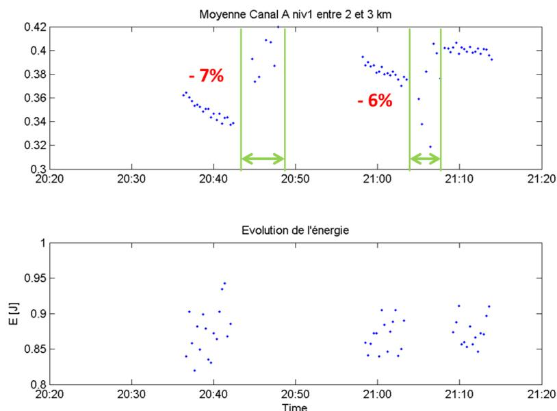
**FIGURE 4.1** Variation du signal moyen du canal Rayleigh/Mie interne entre 2 et 3 km durant les visées verticales de la soirée du 6 juillet 2015 (*Haut*) et variations de l'énergie laser associées (*Bas*)
