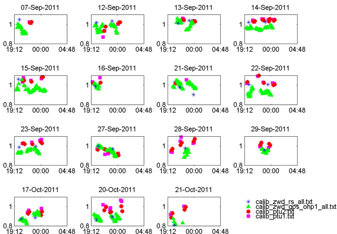
**FIGURE 2.2** Évolution des coefficients d'étalonnage H<sub>2</sub>O nuit par nuit pour différentes méthodes d'étalonnage (Démévap). (\*) CIVE radiosondages (△) CIVE GPS (○,□) PTU 1 et 2
