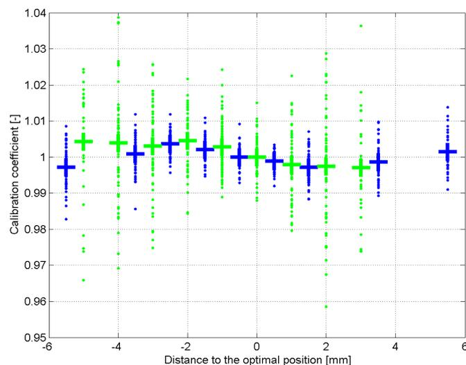
**FIGURE 3.30** Variations du coefficient d'étalonnage enregistrées lors du test de la taille du spot à l'entrée de la fibre pour deux configurations optiques. *Bleu* Configuration non optimisée de Démévap. *Vert* Configuration optimisée 1 : boîtier long/petite fibre
