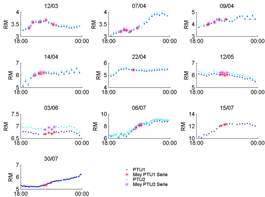
**FIGURE D.2** Rapports de mélange des PTU placés à 15 m de hauteur pour les nuits d'expérimentation. Les étoiles correspondent à la valeur moyenne des PTU pendant la durée des enregistrements des profils lidar.
