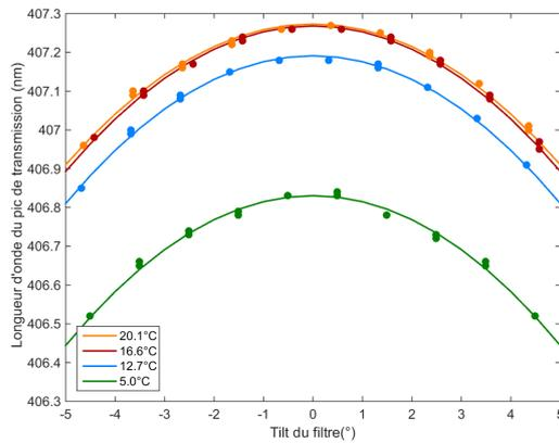
**FIGURE 3.10** Longueur d'onde du maximum de transmission à travers un filtre Barr étroit centré en  $407,63$  nm en fonction du tilt pour différentes températures. Les points correspondent aux données expérimentales que l'on ajuste par moindres carrés à une parabole.
