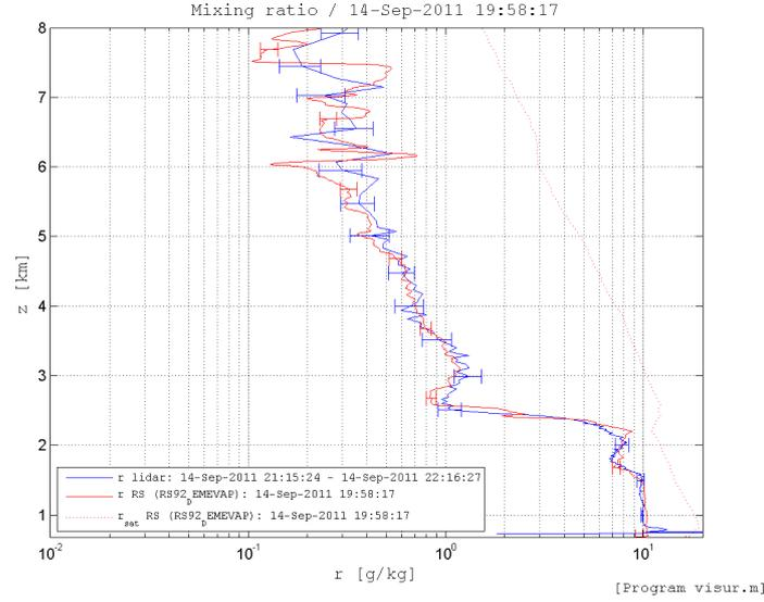
**FIGURE A.15** Rapport de mélange du lidar (bleu) et du Radiosondage (rouge) pour la série H<sub>2</sub>O du 14/09/2011 (Démévap)
