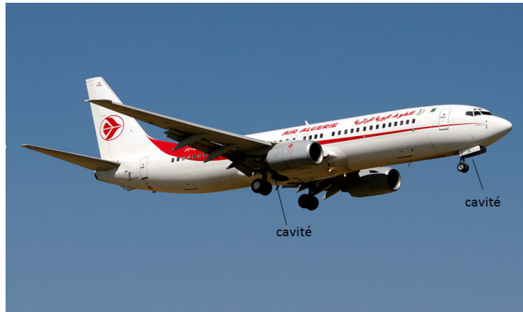
FIGURE 1.4 – Les trappes ouvertes d’un train d’atterrissage d’avion : est une source de bruit due à la présence de cavités ouvertes.
