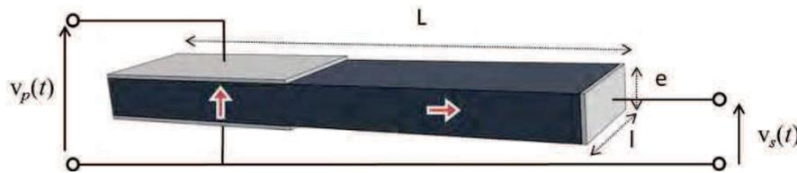
Figure 7 - Architecture du transformateur de type Rosen
