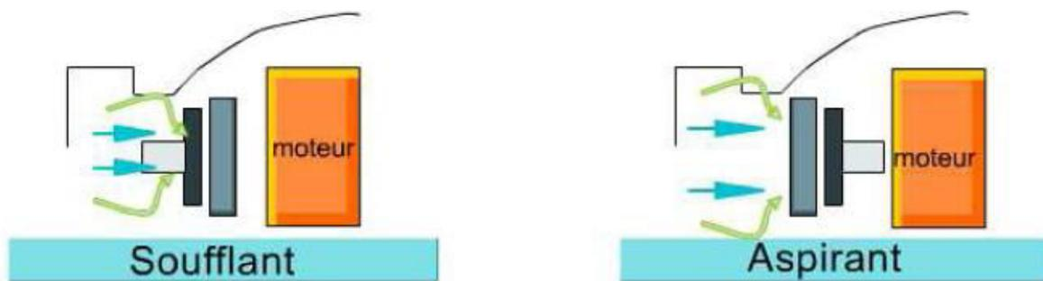
Figure 43 : Illustration des deux architectures possibles du groupe moto ventilateur
