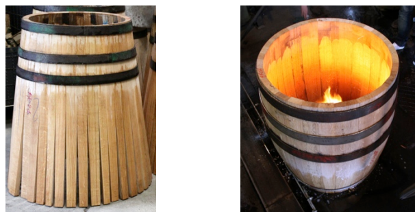
Figure 7 : A gauche les douelles sont mises en rose et cerclées ; à droite chauffe et serrage d'un tonneau à l'aide d'un câble d'acier se resserrant progressivement en bas. (Olivier Colas CC BY-SA 3.0 via Wikimedia Commons)
