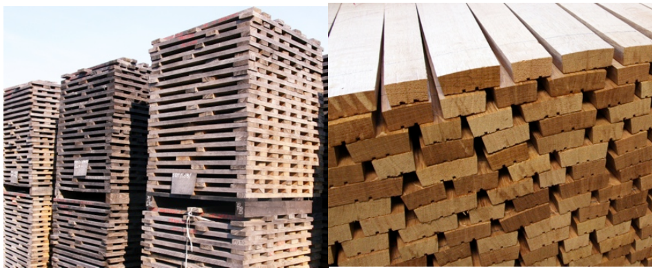
Figure 6: A gauche les merrains sont séchés en plein air ; à droite les douelles avant l'assemblage.
