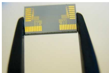
Figure 2.1. Photographie de la structure de test réalisée sur Si massif.
