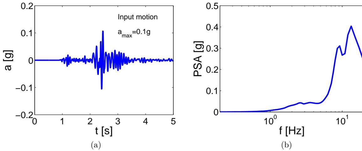
Figure C.11: irsn60: a) Accelerogram, b) Spectrum ( $\xi=5\%$ ).
