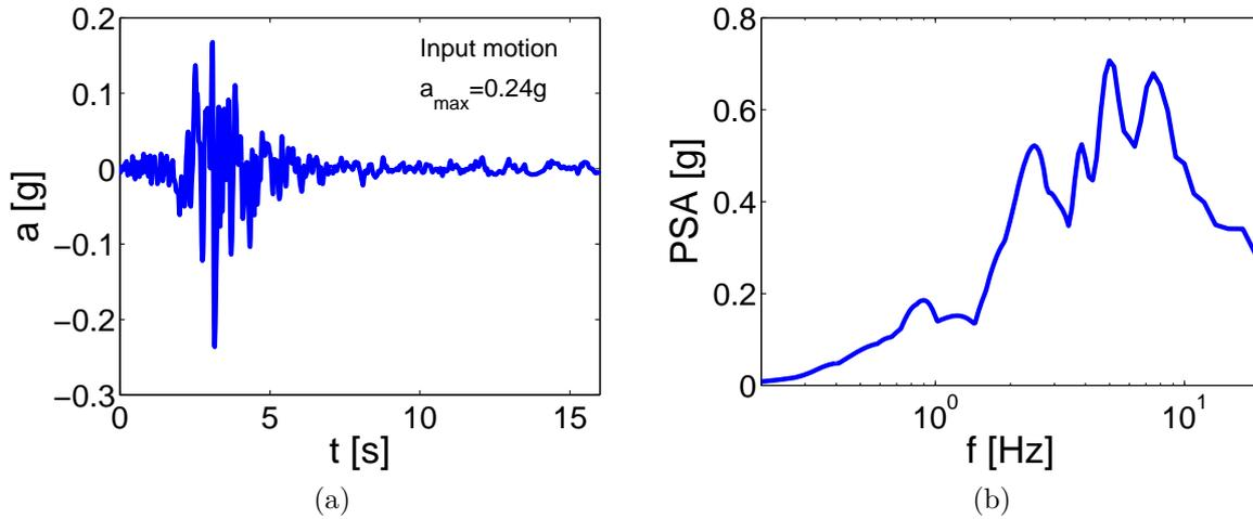
Figure C.10: Friuli earthquake: a) Accelerogram, b) Spectrum ( $\xi=5\%$ ).
