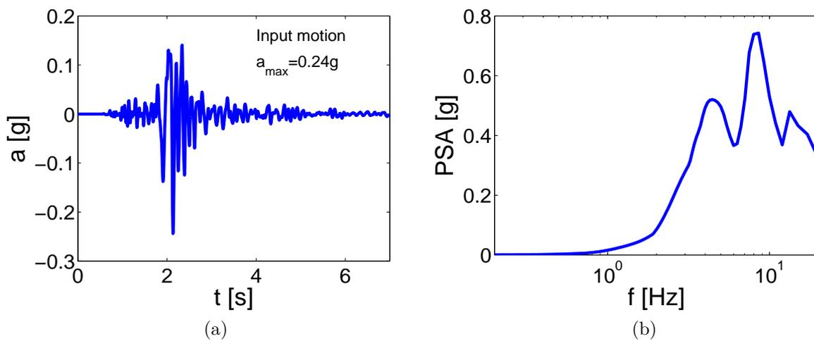
Figure C.12: irsn168: a) Accelerogram, b) Spectrum ( $\xi=5\%$ ).
