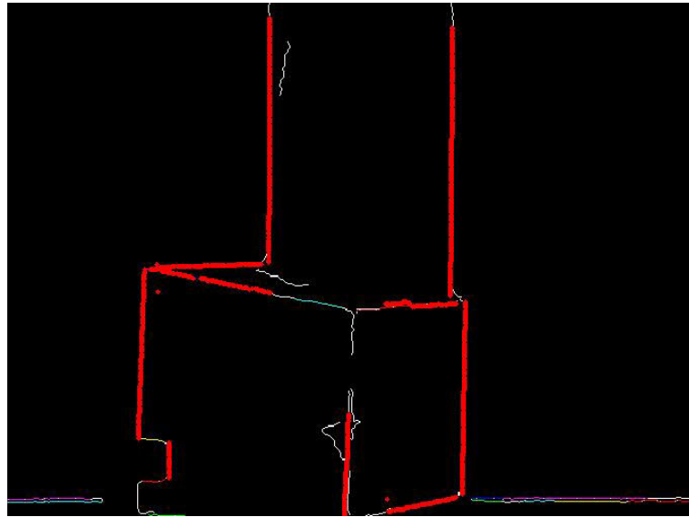
FIGURE 3.33 — Reprojection dans plan image gauche de la figure 3.1 des points 3D reconstruits pour une paire stéréoscopique imageant la pale de turbine test (voir figure 3.1 et 3.25). Les points reprojetés sont en rouge.
