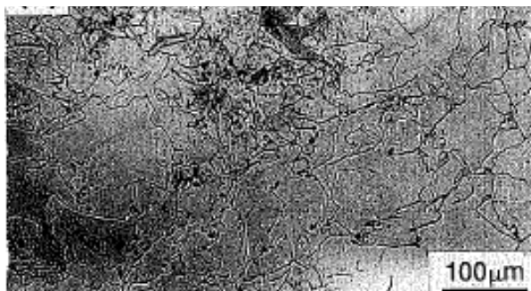
Figure II- 14 : Ferrite massive et précipités de Cu observés en microscopie optique et en MET dans un alliage Fe-4Cu austénisé à 1250°C pendant 1h puis refroidi à l'air [Kim97]
