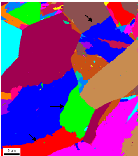
Figure II- 53 : Observation de grains aux joints ondulés et perturbés dans l'alliage Fe-10Cu-15Ni
