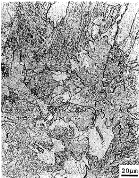
a) Image caractéristique en microscopie optique de ferrite massive – (Acier contenant 0.005C et 3Mn obtenue avec une vitesse de refroidissement de 50^{\circ}\text{C/s} ) [Kra95]
