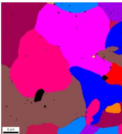
Figure II- 69 : Observation de grains aux joints ondulés dans l'alliage Fe-10Cu refroidi à 0.03°C/s
