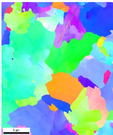
Figure A2- 6 : Cartographie d'orientation des grains suivant la normale à l'échantillon pour l'alliage Fe-3.5Cu-10Ni trempé à l'eau – Mise en évidence des désorientations entre les grains (changement de couleur).
