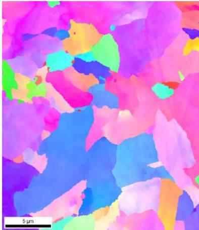
Figure A2- 6 : Cartographie d'orientation des grains suivant la normale à l'échantillon pour l'alliage Fe-3.5Cu-10Ni trempé à l'eau – Mise en évidence des désorientations entre les grains (changement de couleur).
