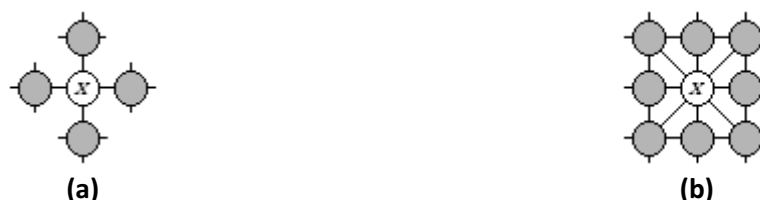
Figure 187 : Enveloppes des voisinages géodésiques d'un point/pixel x (a) 4-connecté et (b) 8-connecté
