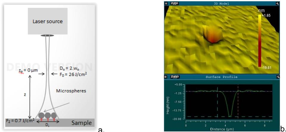
Figure 2. (a) Montage expérimental pour la gravure par JP à l'aide de microsphères (b) Profil d'une gravure typique réalisée dans un wafer de silicium wafer à l'aide de microsphères de verre de  $6 \mu\text{m}$ . Fluence sur les billes :  $0,7 \text{ J/cm}^2$ . Fluence calculée au niveau du jet photonique :  $71/\text{cm}^2$ .
